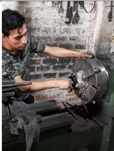
FIGURA 5: Falta de EPP.
