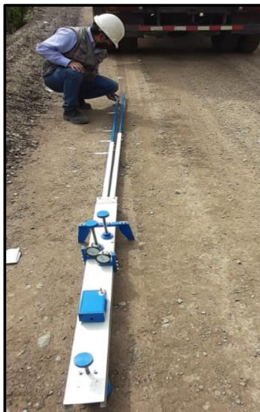
Figura 2: Viga Benkelman empleada en obra
