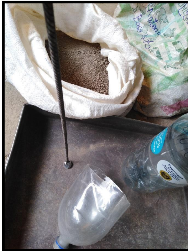
Herramientas artesanales para el compactado y llenado de la muestra en el interior del envase PET.
