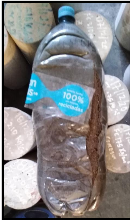
Resultado de la unidad PET sometida a esfuerzos de compresión uniaxial transversal.
