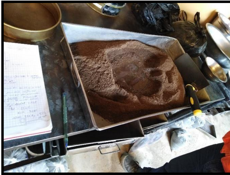
Muestra pasante del tamiz #4 lista para ser uniformizada con el agua, paso necesario para ejecutar el ensayo Proctor.
