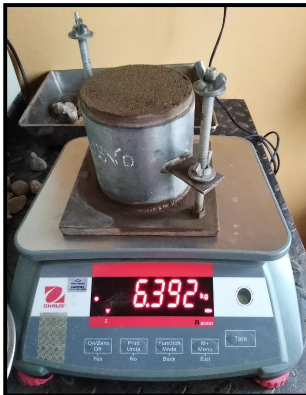
Pesado al volumen del molde Proctor con la muestra enrasada.
