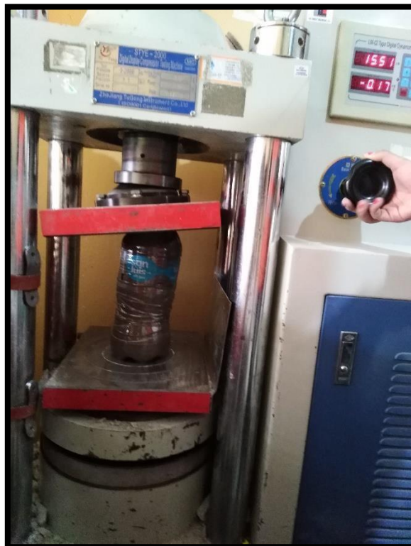
Prensa que comprime uniaxial mente el eje más largo de la unidad PET.
