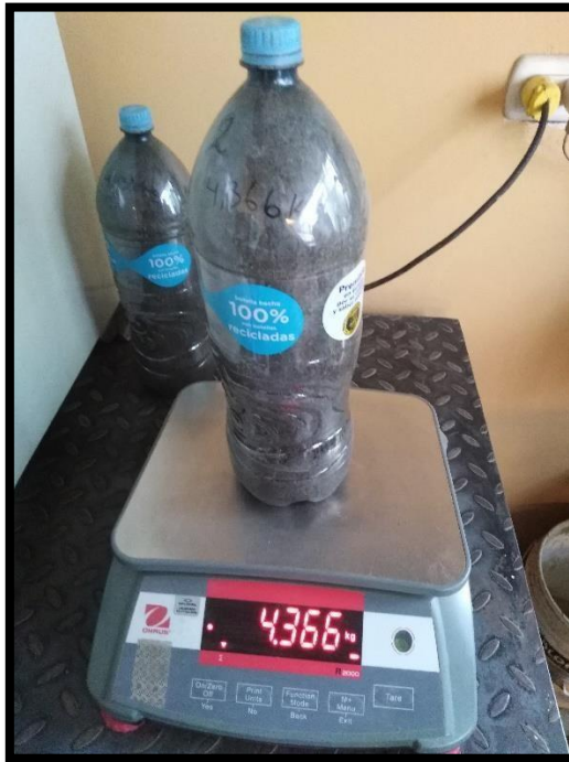
Pesado del envase PET y la muestra elegible que fue llenada y compactada.
