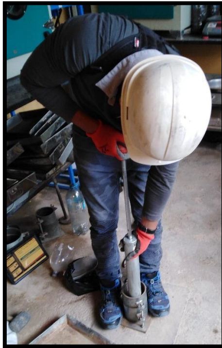
Compactado al volumen de muestra dentro del molde Proctor.
