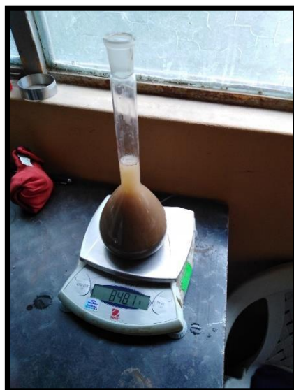
Pesado de la fiola, muestra de suelo y agua.
