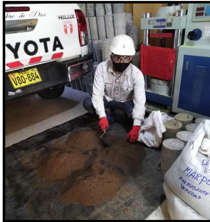
Procedimiento del cuarteo del material extraído de la cantera Lalito.
