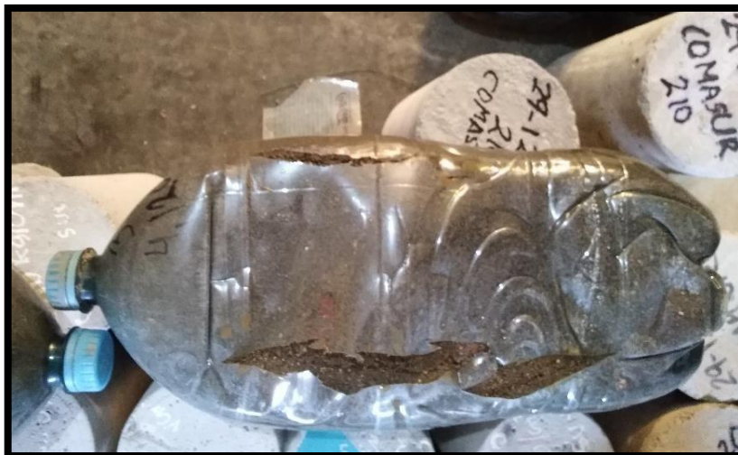
Los cortes de los envases PET son paralelos al eje más largo de la unidad PET.
