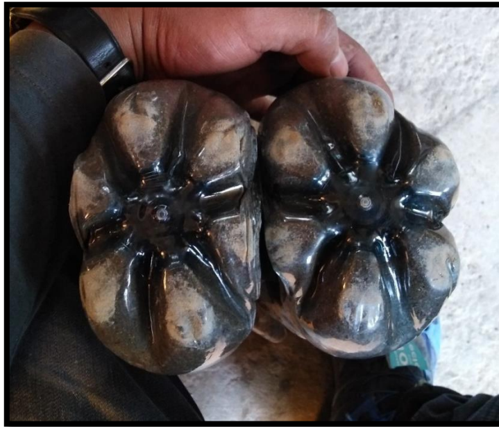
Base de la unidad PET donde se observa que el envase no sufre rotura alguna frente a la compresión uniaxial longitudinal.
