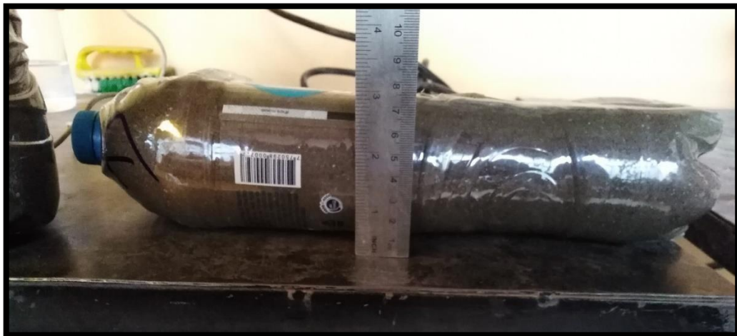
Muestra del aplastamiento de la unidad PET, llegando a reducir hasta 3.73cm del total de 10.725cm.
