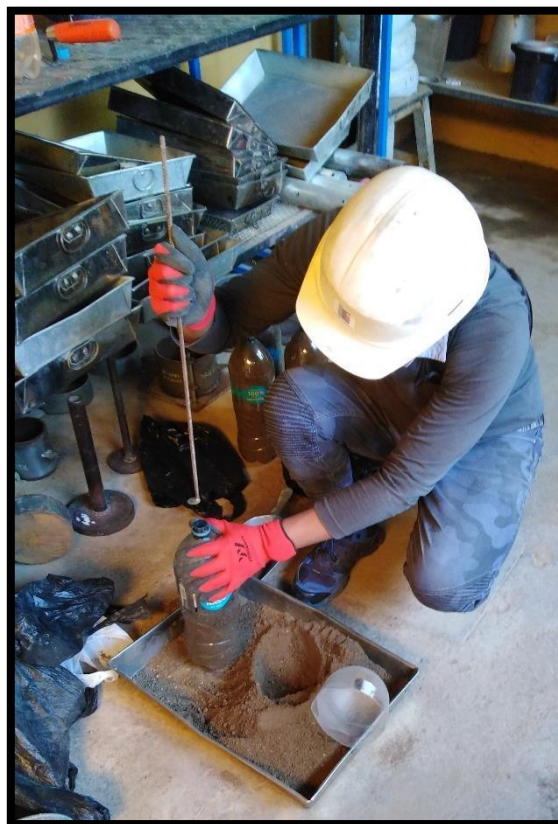
Compactado de la muestra con 7 golpes cada tramo.
