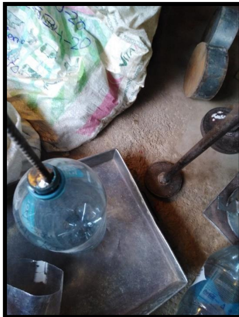
El diámetro de la plancha circular del elemento vertical de compactación pasa libremente por la boquilla del envase PET.
