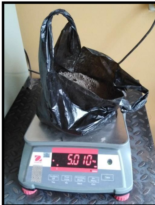
Pesado de muestra lista para ser mezclada con un porcentaje de agua.
