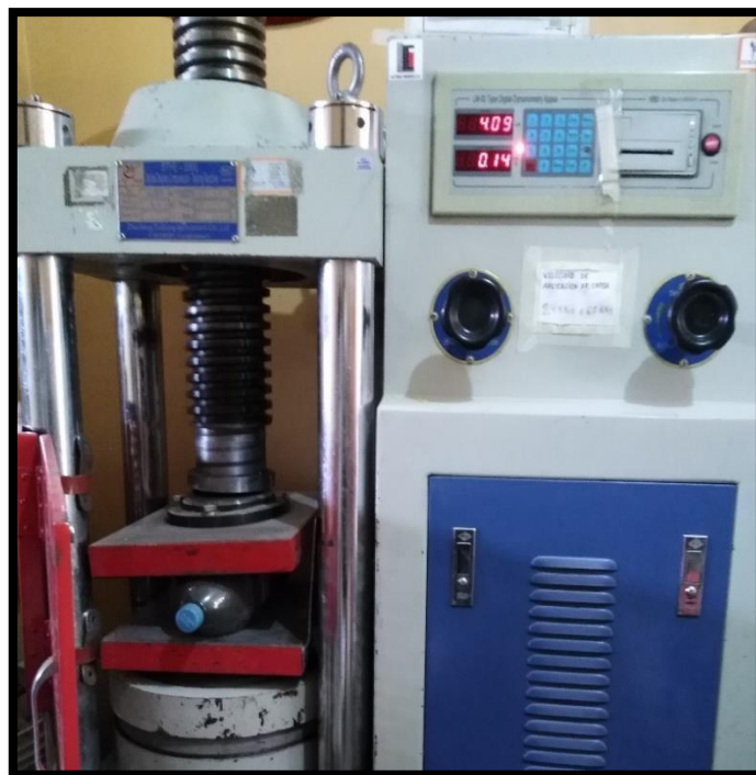
Prensa que comprime uniaxial mente el eje transversal de la unidad PET.
