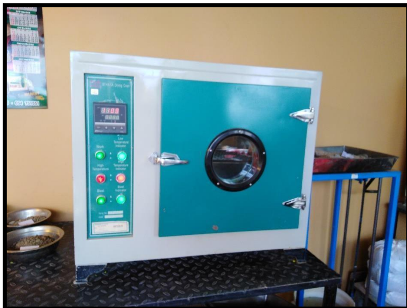
La bandeja y la muestra del suelo están en el horno para su secado.
