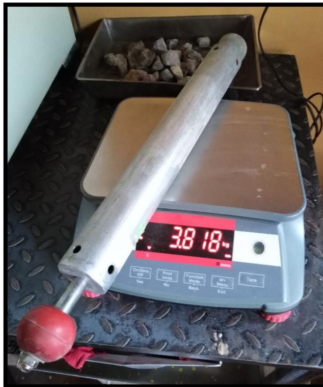
Pesado del maso para la compactación.
