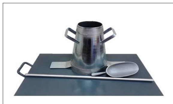
Figura 17 Equipo para ensayo de Asentamiento
