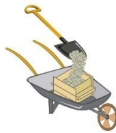
ECHAR EL MATERIAL Y GRANULAR DENTRO DE LA GAVERA, HASTA OBTENER 0.5 p 3 o 1 p 2
