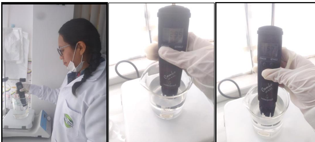
Figura 9: Medición del pH inicial de la muestra de agua ácida de mina y posterior modificación a pH 5
