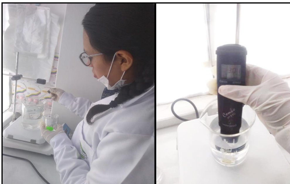
Figura 10: Modificación del pH inicial de la muestra de agua ácida de mina con una solución de HCl a 1M
