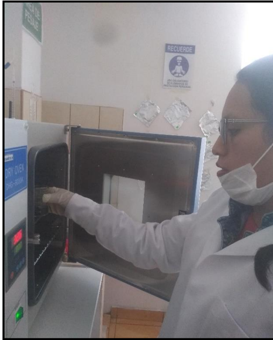
Figura 7: Proceso de secado del endocarpio de aceituna activado
