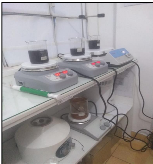
Figura 12: Desarrollo de las pruebas de cinética y equilibrio de adsorción del Mn (II) y Cu (II)
