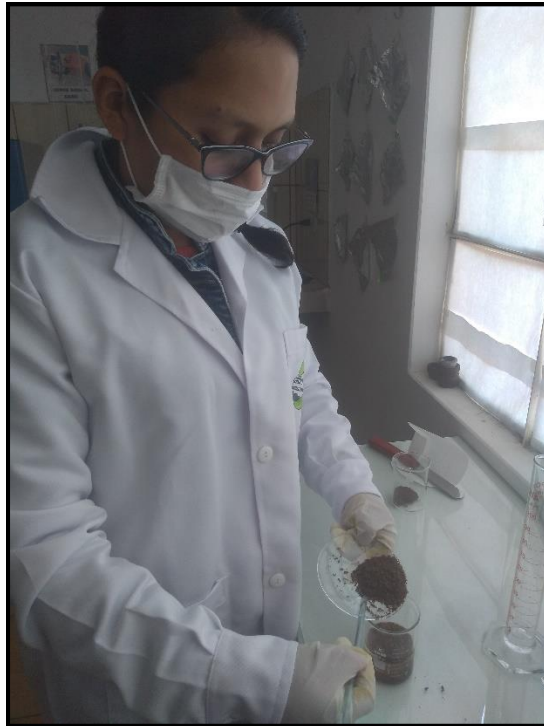
Figura 6: Activación del endocarpio de aceituna con el agente activante (ácido fosfórico)
