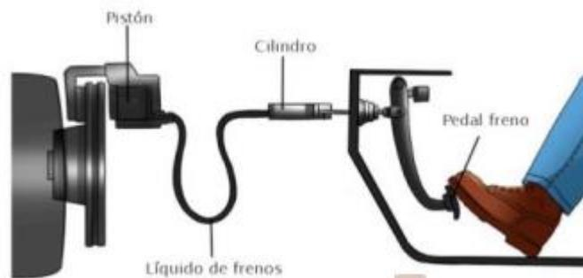
Figura 2. Elementos del freno hidráulico.
