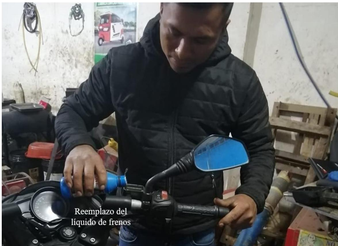
Reemplazo del líquido de frenos
