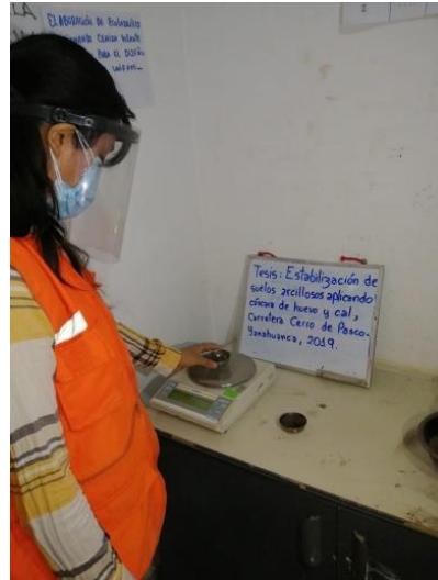
Fotografía 23. Pesado de la muestra utilizada en los límites de consistencia
