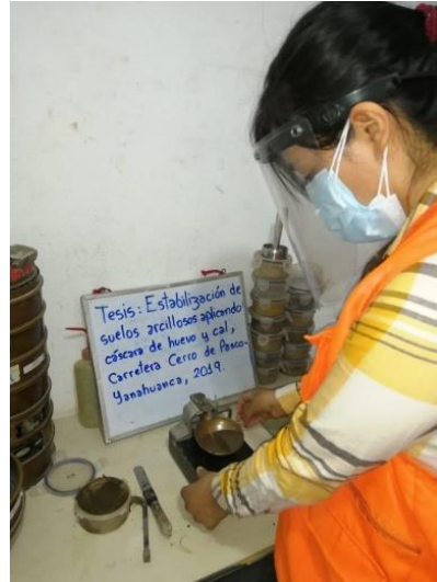
Fotografía 21. Movimientos de la manivela, para suministrar los golpes necesarios para cerrar la ranura.
