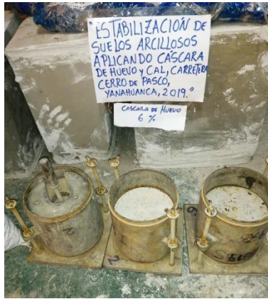
Fotografía 30. Moldes, con adición de 6% de cáscara de huevo, compactados con 56, 25 y 12 golpes
