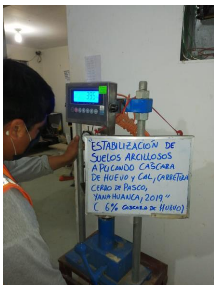
Figura 30. Penetración en la prensa CBR, de la muestra natural con 6% de cáscara de huevo
