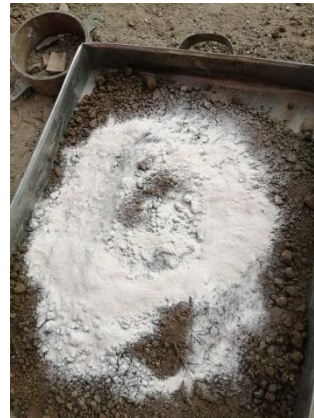
Fotografía 27. Mezcla del aditivo y la muestra natural
