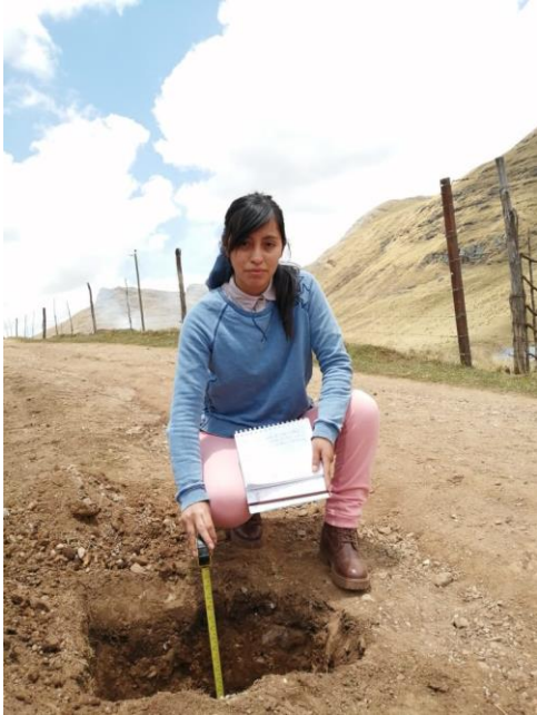
Fotografía 7. Realización de la calicata 01
