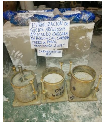
Fotografía 31. Moldes, con adición de 9% de cáscara de huevo, compactados con 56, 25 y 12 golpes
