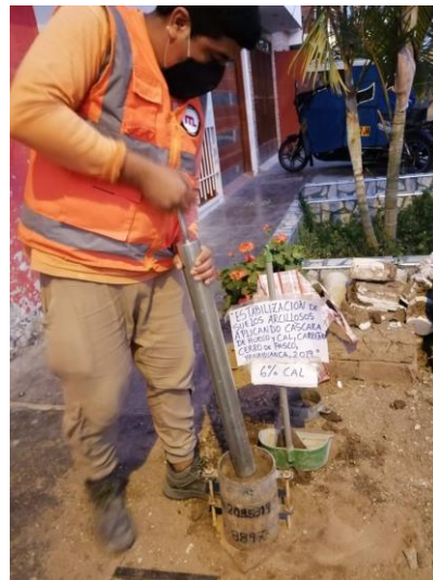
Fotografía 29. Compactación de muestras con la adición de cal.
