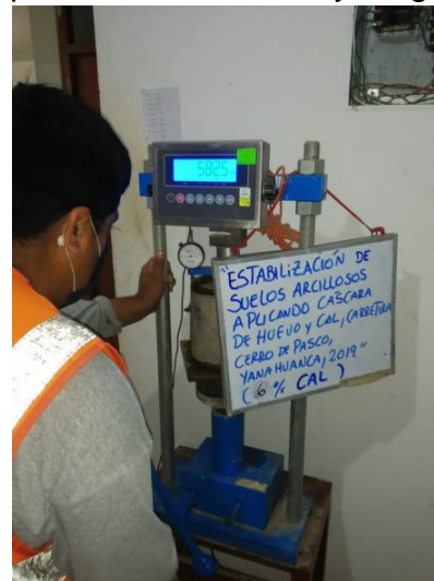
Fotografía 33. Penetración del pistón a la muestra con adición de 6% de cal
