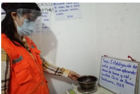
Fotografía 16. Pesado de la muestra natural que paso la malla N°200
