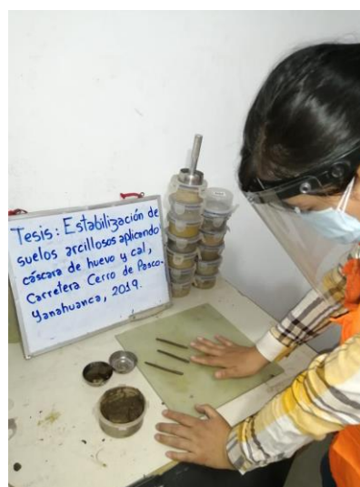
Figura 27. Ejecución del ensayo de límite de Atterberg (límite plástico)
