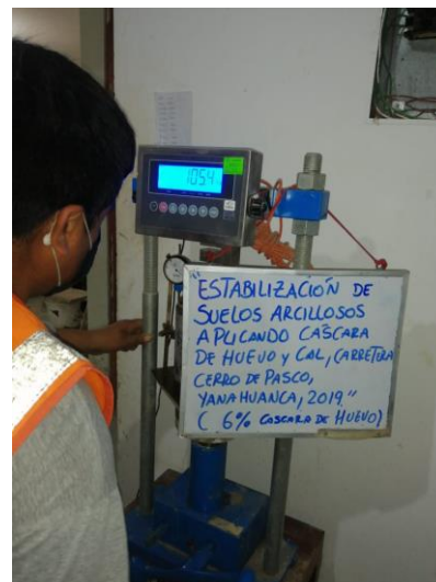
Fotografía 35. Penetración del pistón a la muestra con adición de 6% de cáscara de huevo
