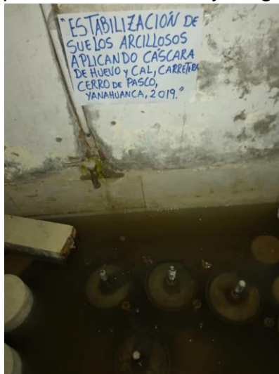
Fotografía 32. Los moldes del CBR se sumergen por 96 horas.
