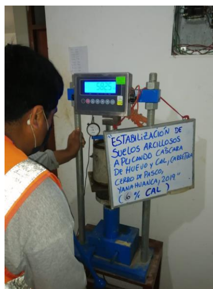
Figura 31. Penetración en la prensa CBR, de la muestra natural con 6% de cal
