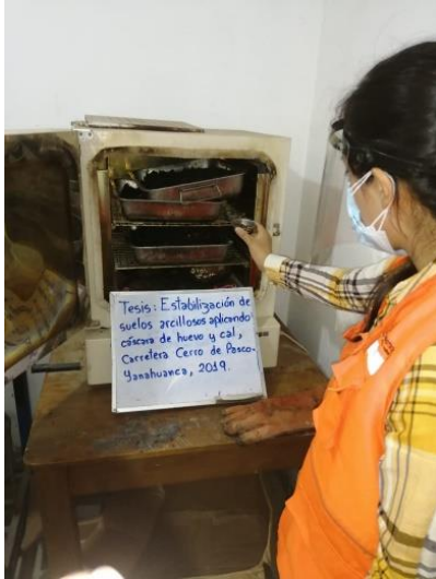
Fotografía 24. Colocación de muestra en el horno eléctrico
