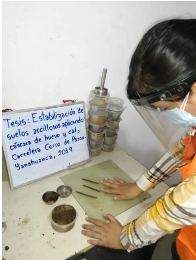
Fotografía 22. Determinación del límite plástico
