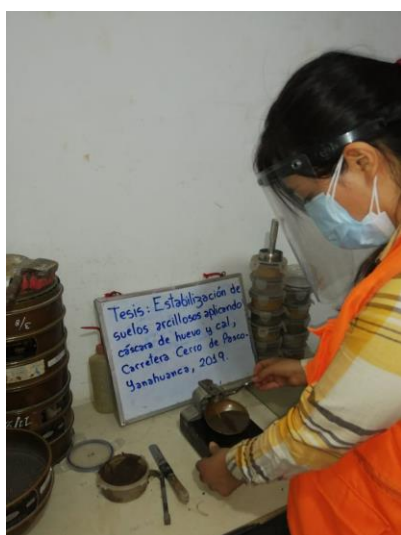
Figura 26. Ejecución del ensayo de límite de Atterberg (límite líquido)
