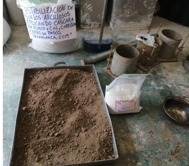
Fotografía 25. Materiales para la realización del Proctor Modificado y CBR
