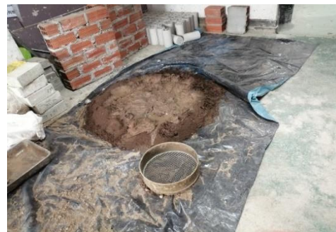
Fotografía 14. Suelo a estabilizar
