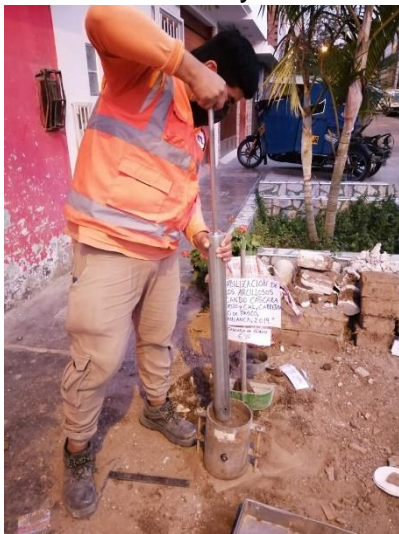
Fotografía 28. Compactación de muestras con la adición de cáscara de huevo
