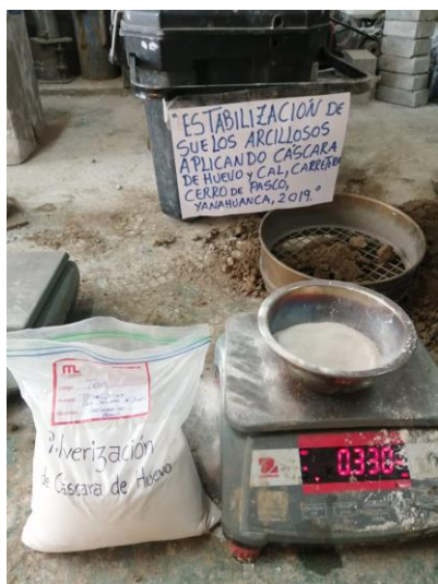
Figura 28. Pesaje de los estabilizantes para la ejecución del ensayo Proctor Modificado
