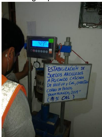
Fotografía 34. Aplicación de carga a la muestra con adición de 9% de cal
