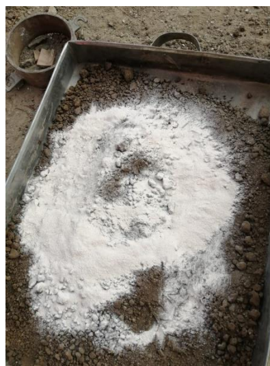
Figura 29. Mezcla de la muestra natural y los estabilizantes, para la ejecución del ensayo Proctor Modificado
