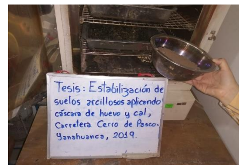
Fotografía 17. Muestra secada en el horno eléctrico
