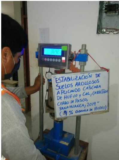
Fotografía 36. Aplicación de carga a la muestra con adición de 9% de cáscara de huevo
