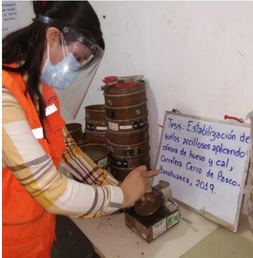
Fotografía 20. El acanalador se pasa sobre el centro de la copa, para cortar la pasta del suelo en dos
