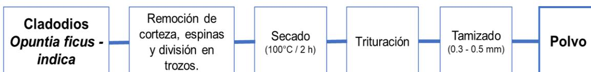
*Figura 10.* Eficiente proceso de extracción de mucílago en polvo.
