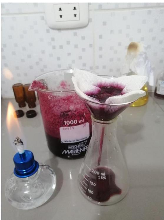
Una vez finalizado ello, se realizó una filtración por medio de gasa estéril y también por medio de papel filtro. El resultante, se colocó en placas Petri y se pasó a una estufa a 40°C, hasta que quedase a una concentración total de 200mg/ml, obteniéndose así, extracto acuoso de *Vaccinium corymbosum* L al 100%.<sup>9, 10</sup>
