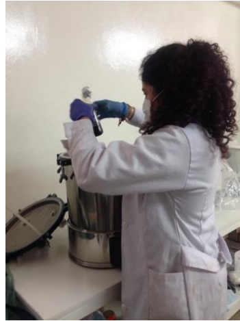
Figura 25 Ingresando los agares a la autoclave.
