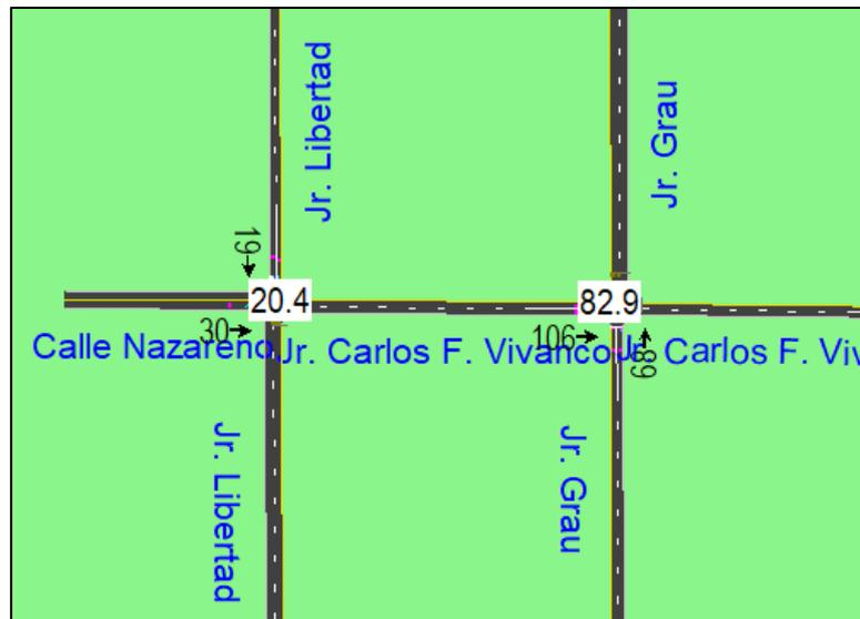
**Figura 114:** Optimización de demoras en intersecciones N° 1 y N°2, con el programa Synchro 8
