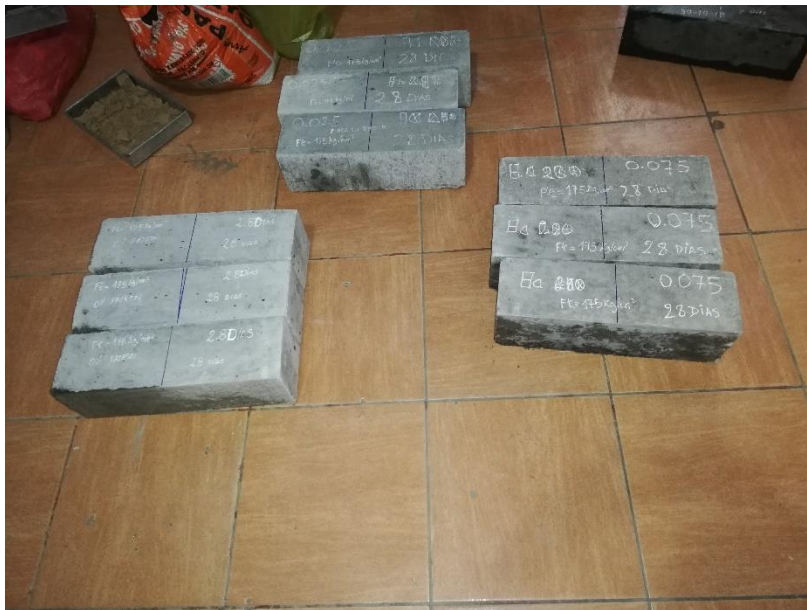
Imagen 66 y 67. Medición de la viguetas que se realizó la prueba a la resistencia de flexión a los 28 días con 0%, 0.025% y 0.075% de fibra de vidrio
