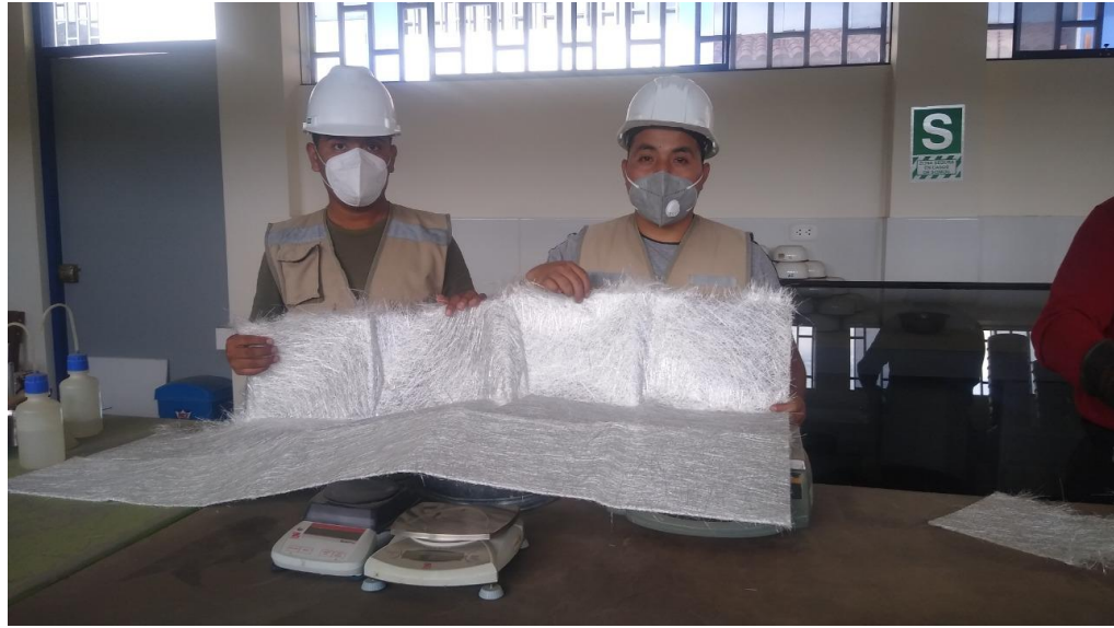
Imagen 34. Fibra de vidrio tipo E, para la adición en el concreto
