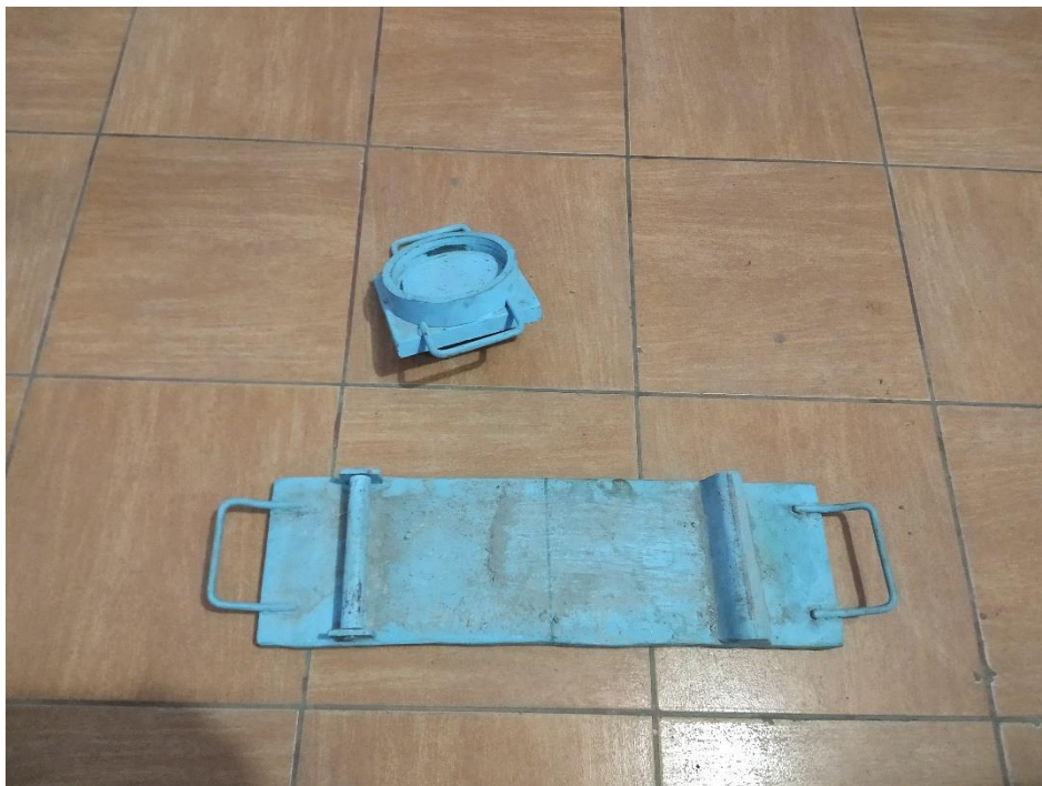
Imagen 55 y 56. Máquina para realizar la prueba a la resistencia de flexión.
