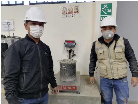
Imagen 28 y 29. Pesos de la prueba de peso unitario suelto y compactado del agregado grueso
