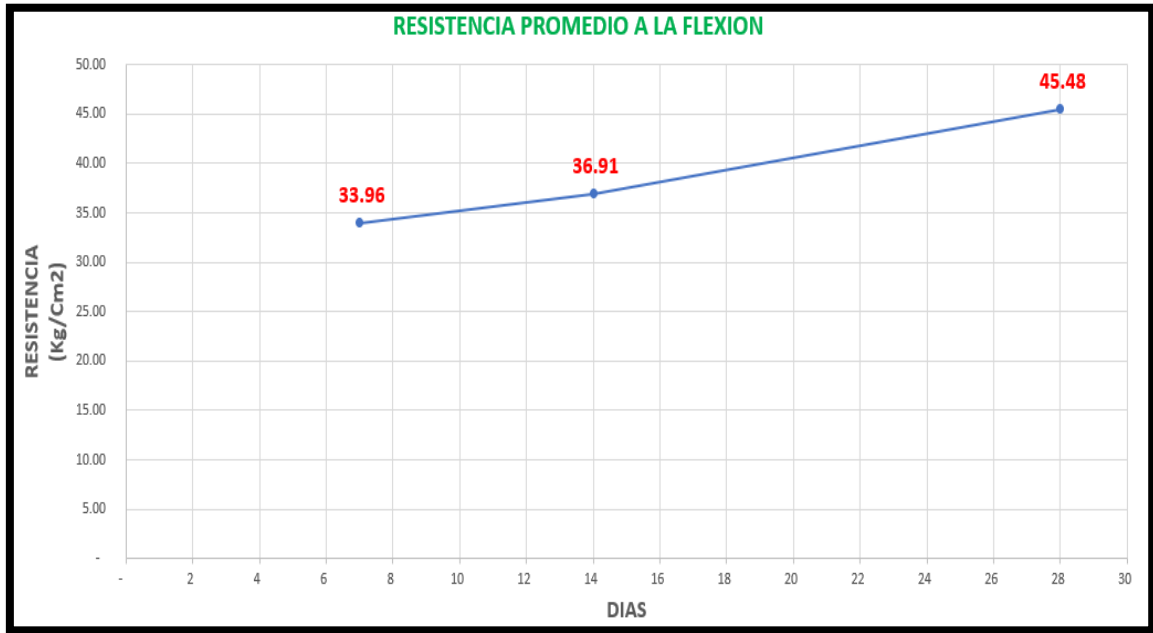
Gráfico 16. Resistencia promedio a la flexión a los 7, 14 y 28 días de edad, con el concreto patrón (0%)
