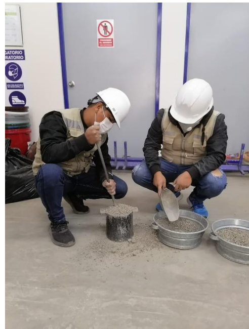
Imagen 30 y 31. Peso unitario suelto y compactado del agregado fino.
