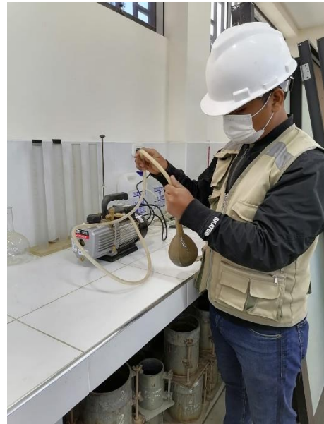
Imagen 22 y 23. Extracción de aire en la fiola , donde está el agregado fino.
