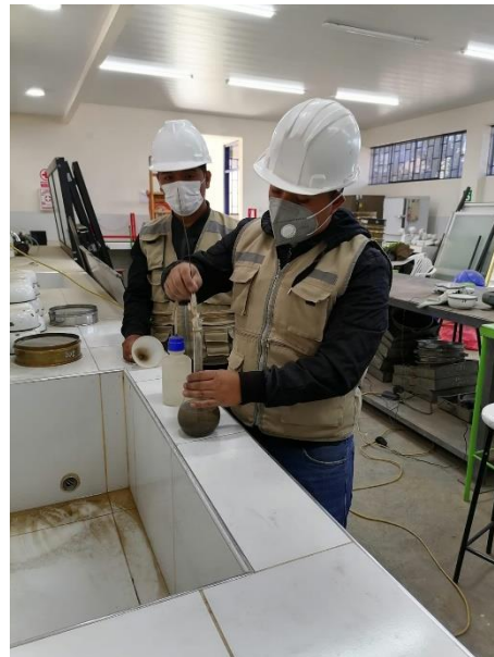
Imagen 20 y 21. Realización de gravedad específica y absorción del agregado fino.
