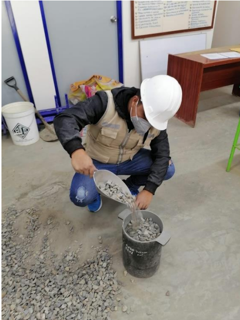
Imagen 26 y 27. Peso unitario suelto y compactado del agregado grueso.
