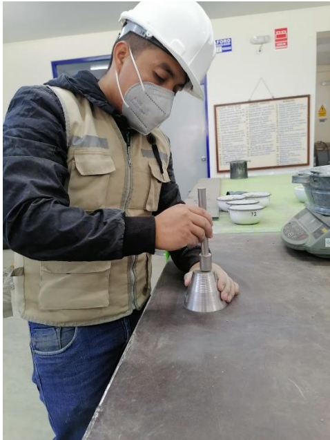
Imagen 24 y 25. Realización en el cono de absorción del agregado fino
