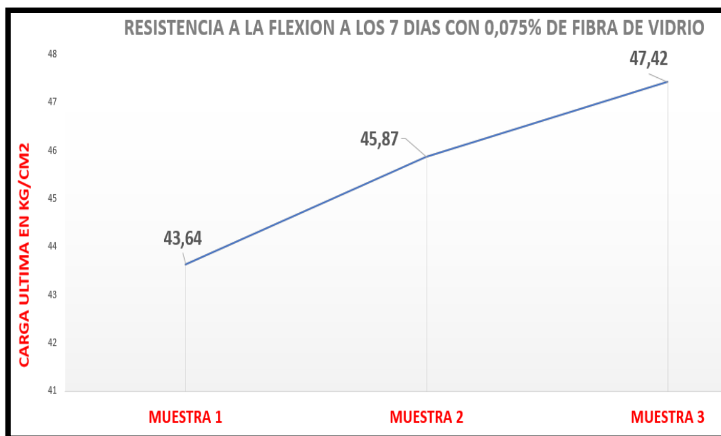
Gráfico 6. Comportamiento de la resistencia a la flexión de viguetas adicionando 0.075% de fibra de vidrio (7días).
