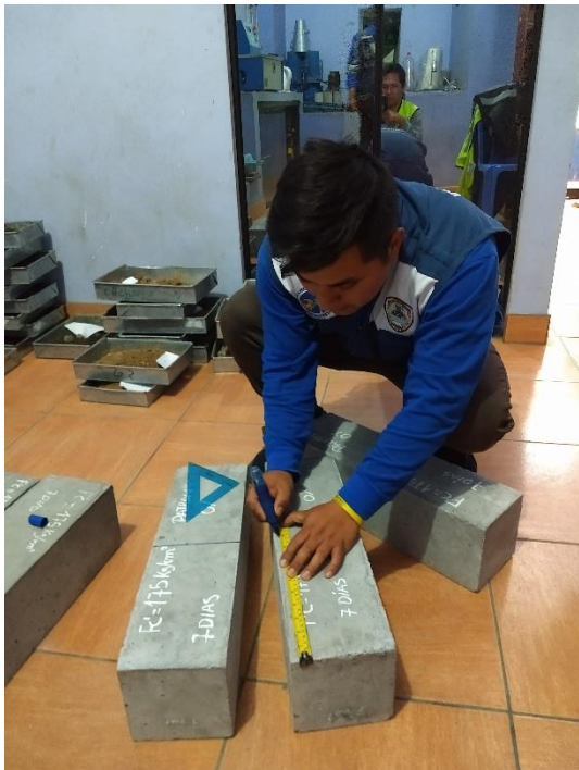
Imagen 53 y 54. Medición de los lados de la vigueta y el punto medio para realizar la prueba a flexión. Se realizó a los 07, 14 y 28 días.
