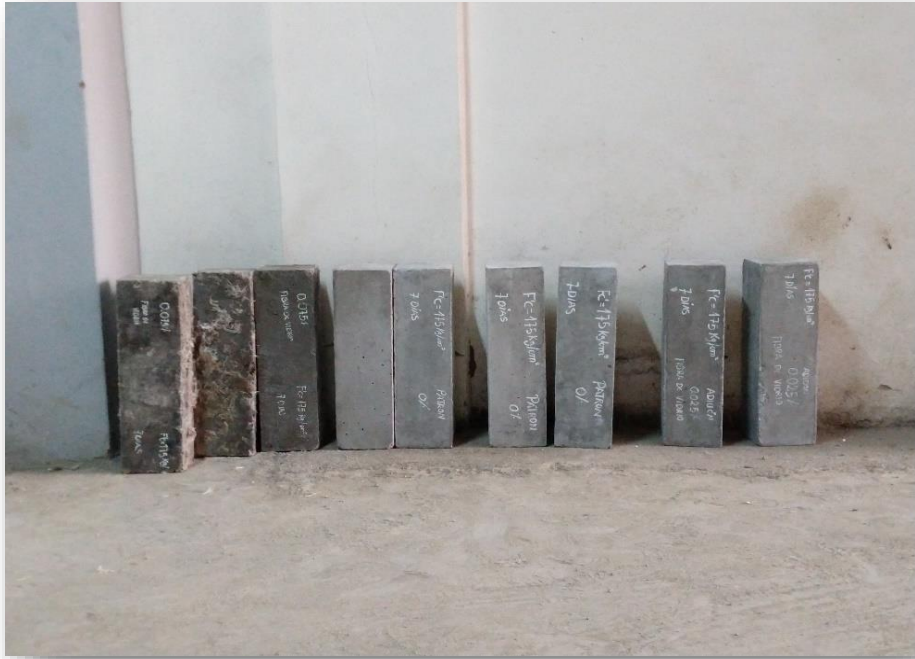
Imagen 50 . Viguetas para la prueba de flexión a los 07 días con 0%,0.025% y 0.075% de fibra de vidrio
