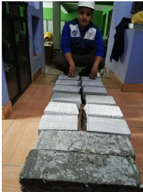
Imagen 68 y 69. Se realizó la prueba a la resistencia de flexión a los 28 días con 0%, 0.025% y 0.075% de fibra de vidrio
