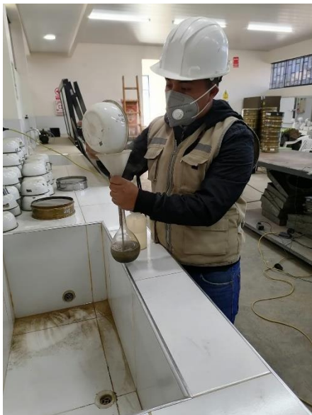
Imagen 20 y 21. Realización de gravedad específica y absorción del agregado fino.
