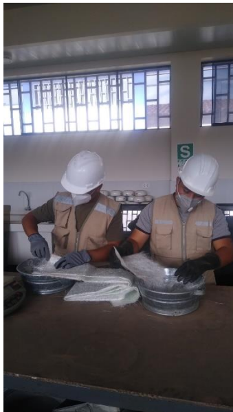
Imagen 35 y 36. Deshilachando la fibra de vidrio para luego pesarlo de acuerdo a la adición en 0.025% y 0.075%
