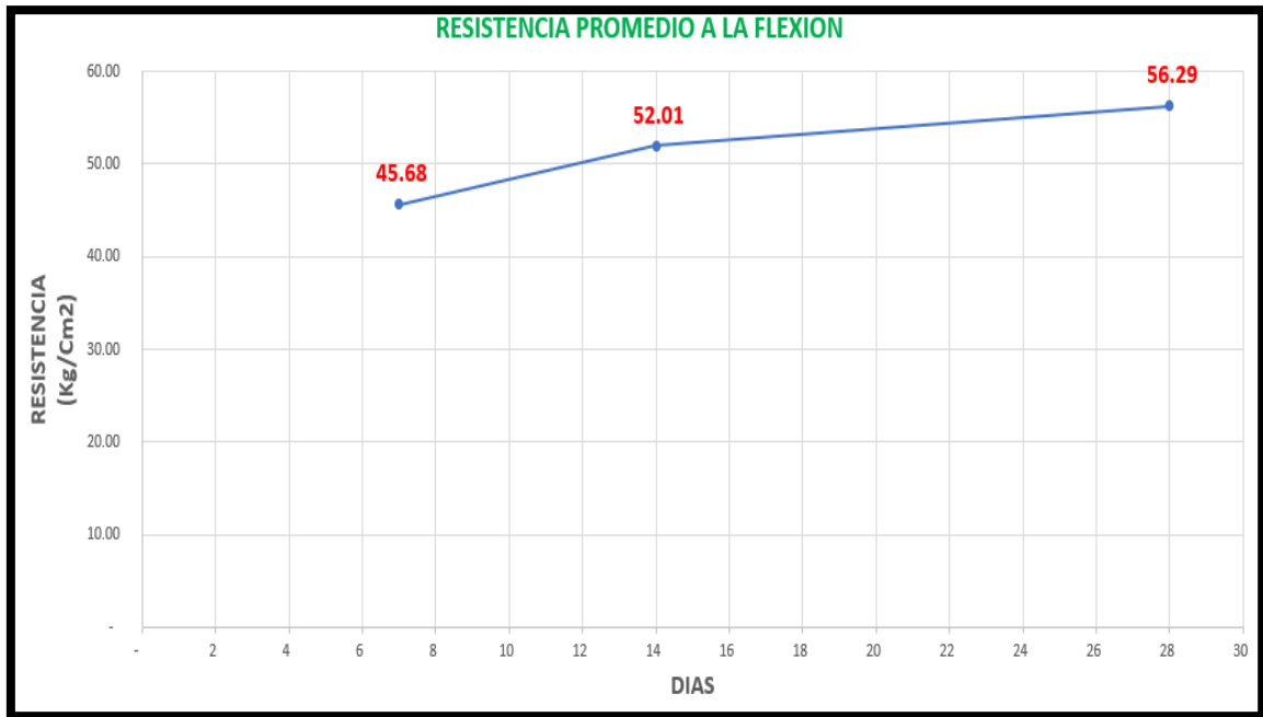
Gráfico 18. Resistencia promedio a la flexión a los 7, 14 y 28 días de edad, adicionando 0.075% de fibra de vidrio.
