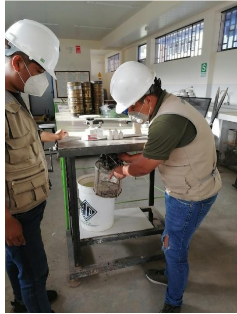
Imagen 16 y 17. Gravedad específica y absorción del agregado grueso
