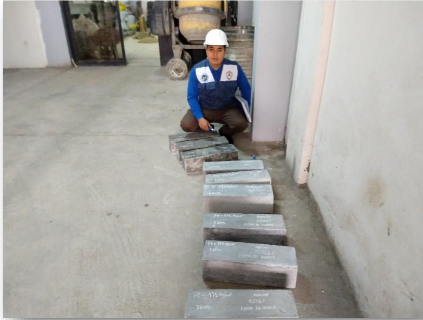
Imagen 52. Viguetas para la prueba de flexión a los 28 días con 0%,0.025% y 0.075% de fibra de vidrio
