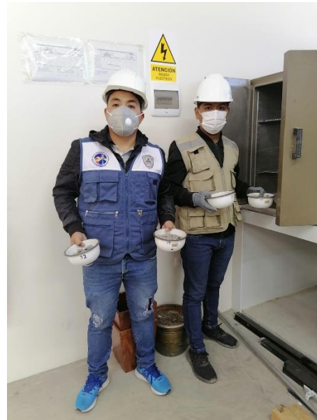
Imagen 6 y7. Muestra de tara en el horno para determinar el contenido de humedad
