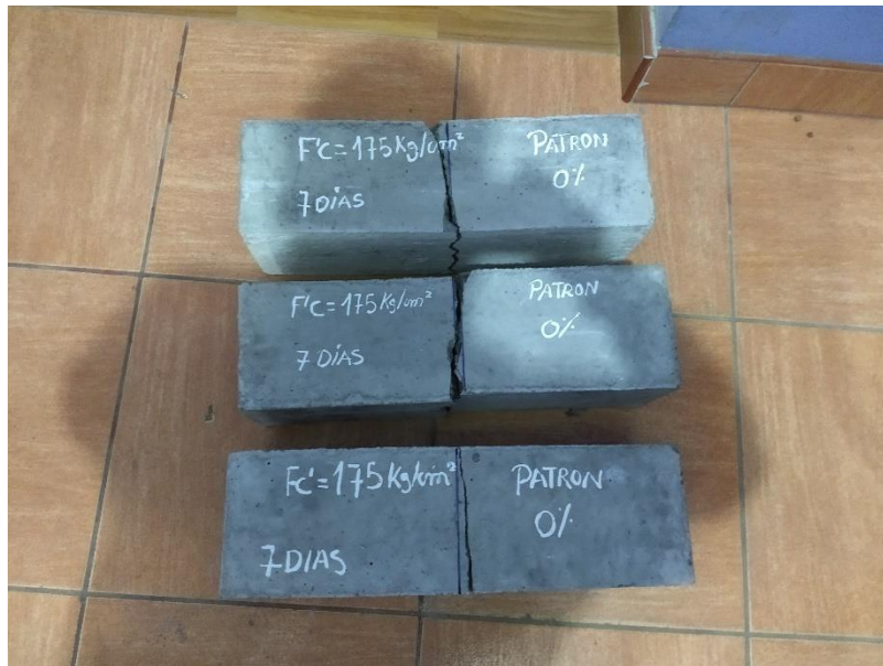
Imagen 59. Prueba de resistencia a la flexión en el punto medio a los 07 días con 0% de fibra de vidrio.
