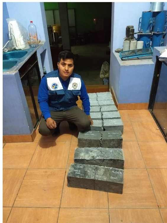
Imagen 60 y 61. Prueba de resistencia a la flexión en el punto medio a los 07 días con 0%, 0.025% y 0.075% de fibra de vidrio.
