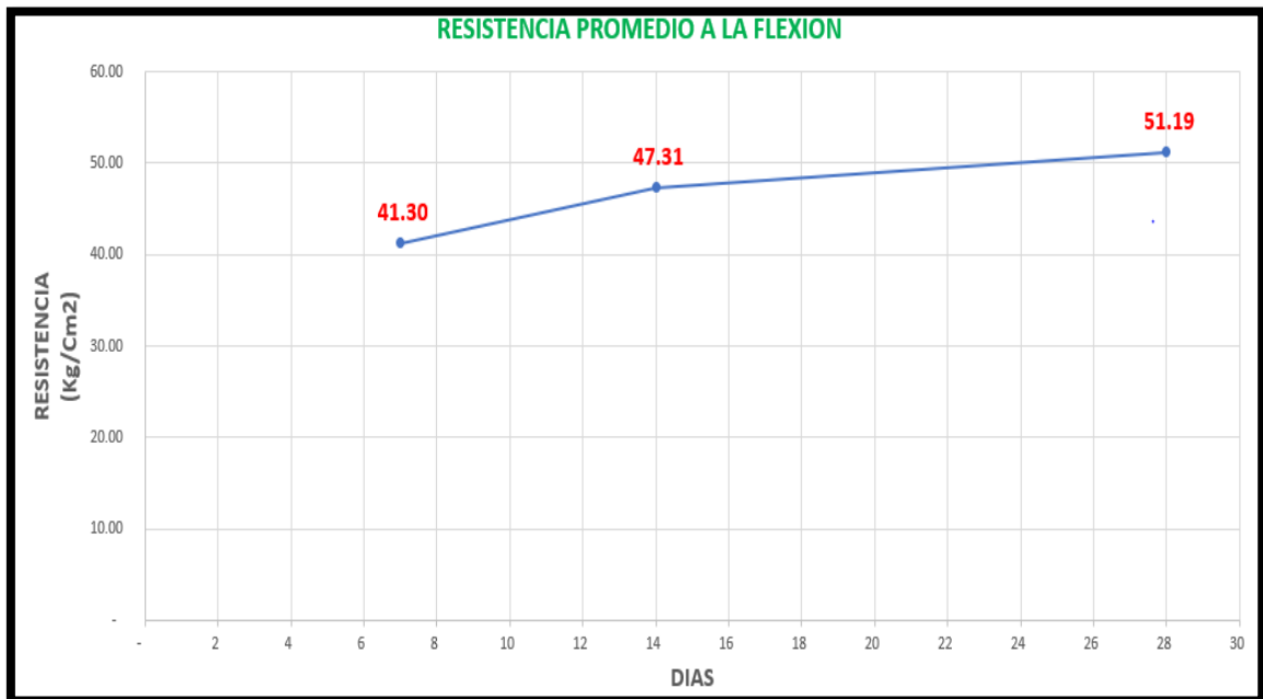
Gráfico 17. Resistencia promedio a la flexión a los 7, 14 y 28 días de edad, adicionando 0.025% de fibra de vidrio.
