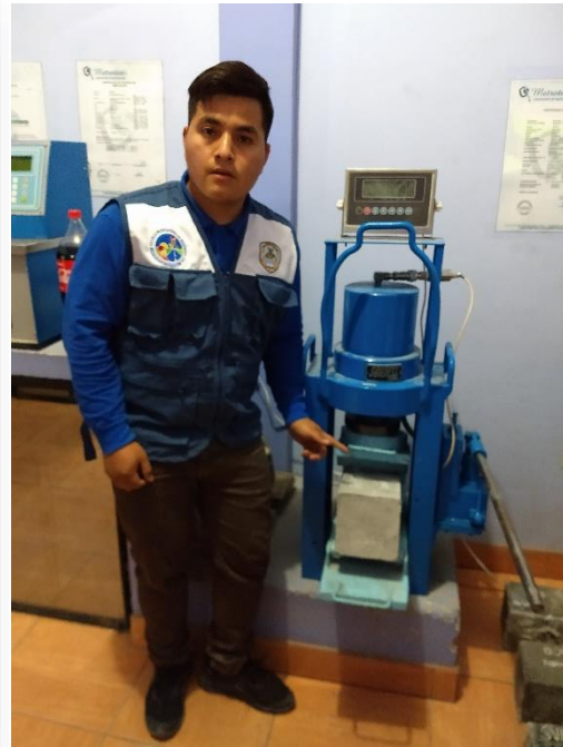
Imagen 57 y 58. Prueba de resistencia a la flexión en el punto medio
