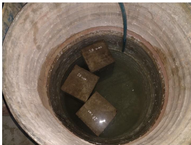
Imagen 47, 48 y 49 . Proceso de curación de las viguetas a los 07, 14 y 28 días, con adición de 0%, 0.025% y 0.075 de fibra de vidrio.
