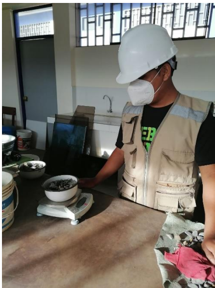
Imagen 14 y 15. Tara seleccionada para la prueba de gravedad específica y absorción del agregado grueso.
