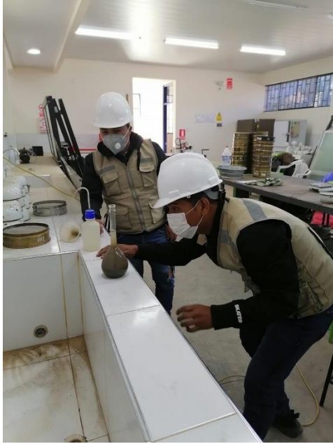
Imagen 22 y 23. Extracción de aire en la fiola , donde está el agregado fino.
