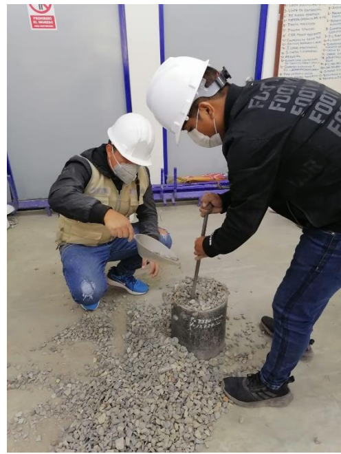
Imagen 26 y 27. Peso unitario suelto y compactado del agregado grueso.
