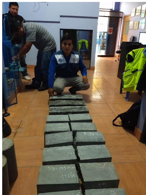
Imagen 64 y 65. Se realizó la prueba a la resistencia de flexión a los 14 días con 0%, 0.025% y 0.075% de fibra de vidrio
