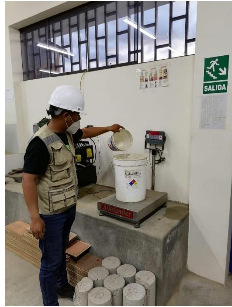
Imagen 37 y 38. Peso de los materiales para la realización del concreto
