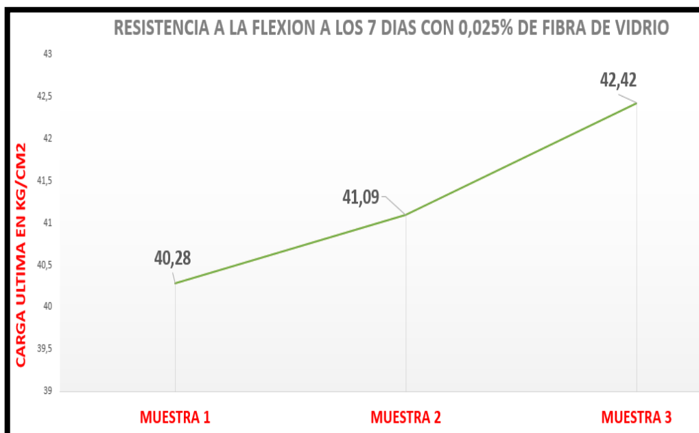
Gráfico 5. Comportamiento de la resistencia a la flexión de viguetas adicionando 0.025% de fibra de vidrio (7 días).
