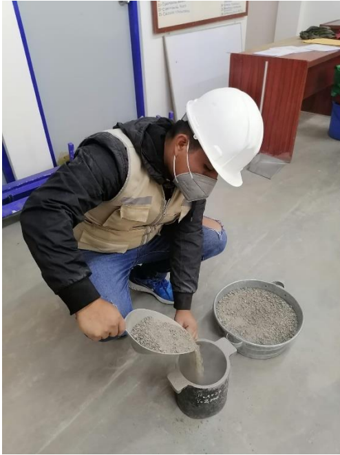
Imagen 30 y 31. Peso unitario suelto y compactado del agregado fino.
