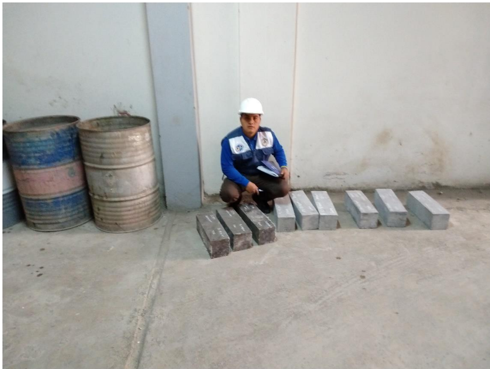
Imagen 51 . Viguetas para la prueba de flexión a los 14 días con 0%,0.025% y 0.075% de fibra de vidrio
