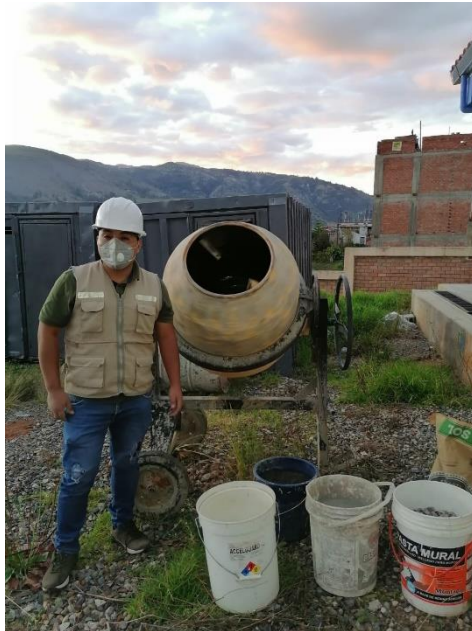
Imagen 41 y 42 . Realización de las viguetas patrón (0% de fibra de vidrio) v su slupm ente 3 a 4”
