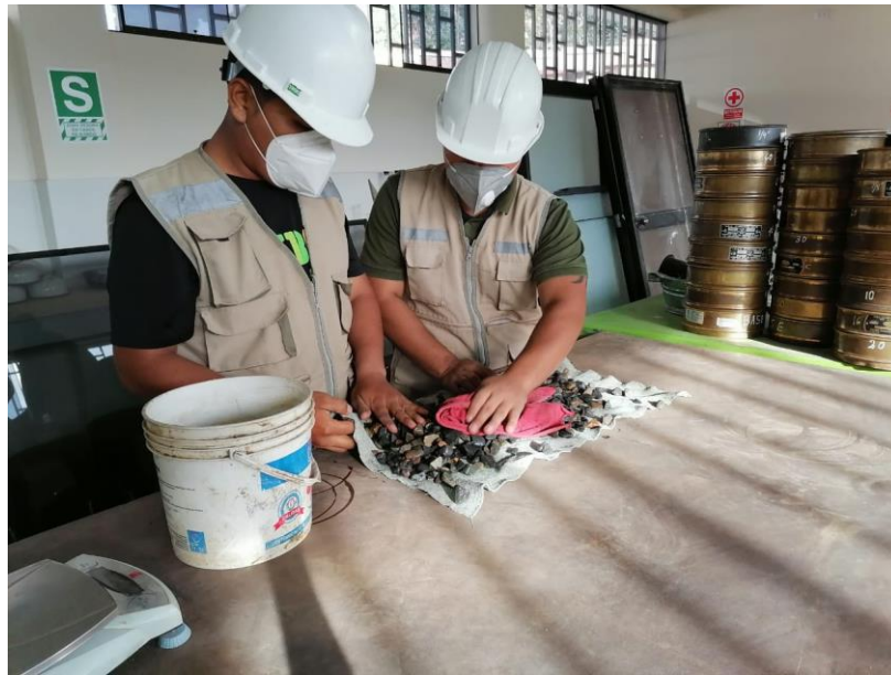
Imagen 13. Secado superficialmente del agregado grueso
