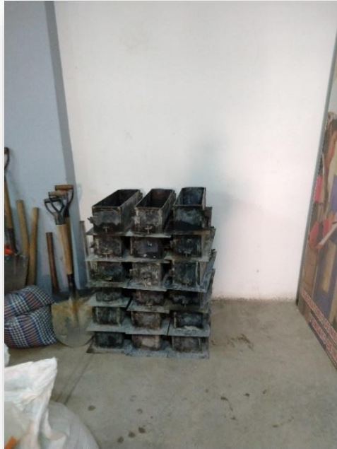
Imagen 39. Moldes para la realización de las viguetas de concreto
