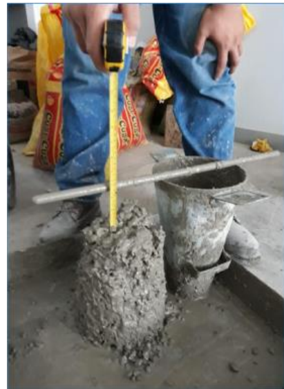
Imagen 41 y 42 . Realización de las viguetas patrón (0% de fibra de vidrio) v su slupm ente 3 a 4”
