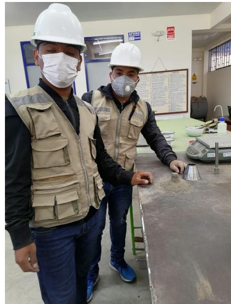
Imagen 24 y 25. Realización en el cono de absorción del agregado fino
