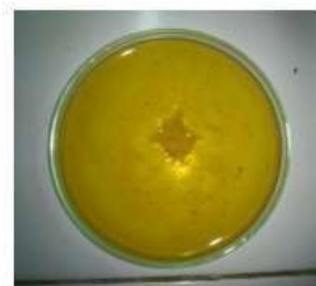
Figura 10. Prueba de biodegradabilidad del bioplástico de cáscara de plátano en agar nutritivo.
