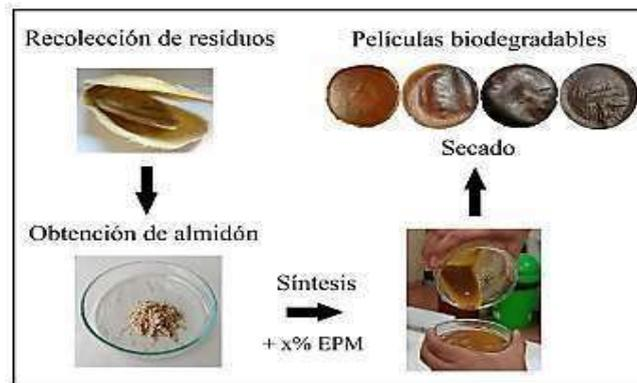
Figura 07. Proceso de elaboración del bioplástico de mango.
