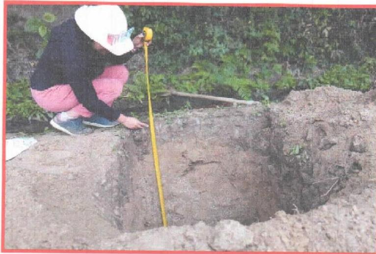
Foto N° 4. Detalle y registro del perfil del suelo en calicata C-5.
