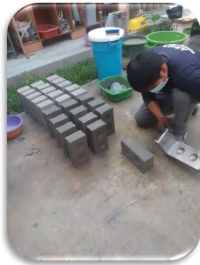
Figura 21: Desarmado del Molde y Extracción del Ladrillo
