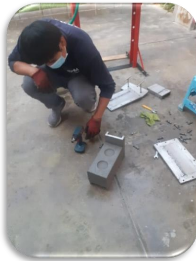
Figura 21: Desarmado del Molde y Extracción del Ladrillo
