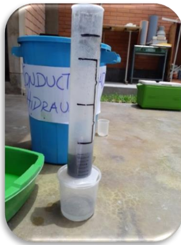
Figura 14: Método de Darcy – Conductividad Hidráulica
