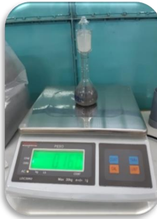
Figura 13: Aumento de agua destilada y peso del picnómetro más agua
