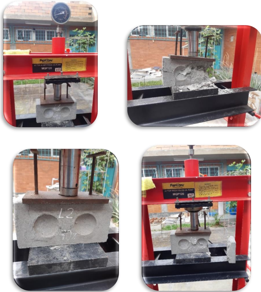
Figura 24: Prueba de Compresión de las 9 muestras
