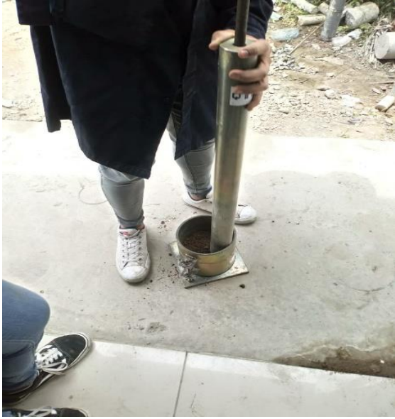
Figura 10. Compactación del material
