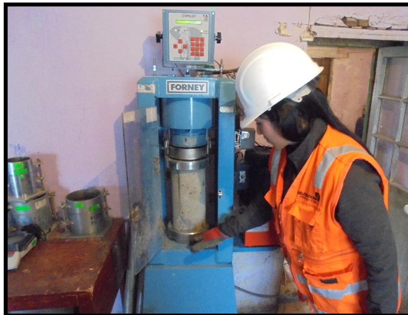
FIGURA N°24: COLOCACIÓN DE PROBETAS IDENTIFICADAS PARA OBTENER RESISTENCIA A LA COMPRESIÓN.
