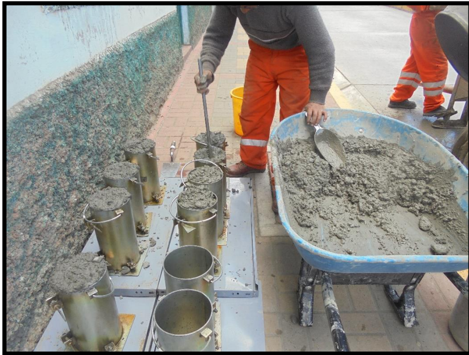
FIGURA N°05: REALIZACIÓN DE PROBETAS EN LABORATORIO
