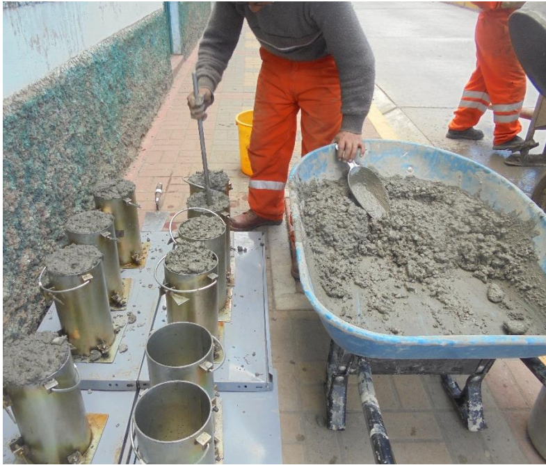
FIGURA N°23: Realización de probetas en laboratorio
