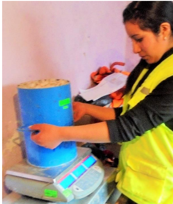
FIGURA N°14: Ensayo de peso unitario suelto (PUS)
