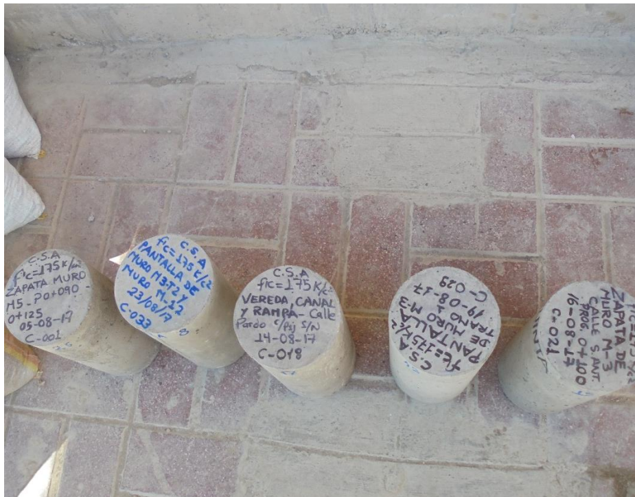
FIGURA N°38: Identificación de probetas según elemento estructural y edades.
