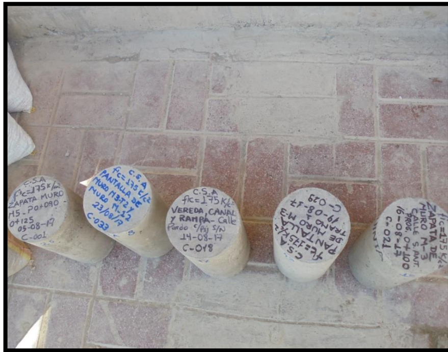
FIGURA N°23: IDENTIFICACIÓN DE PROBETAS SEGÚN ELEMENTO ESTRUCTURAL Y EDADES.
