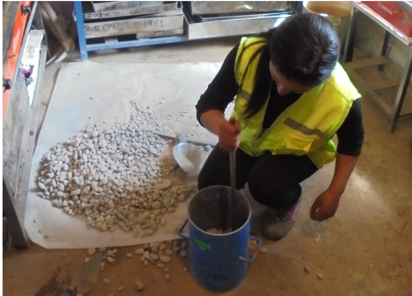
FIGURA N°15: Ensayo de peso unitario compactado (PUC)
