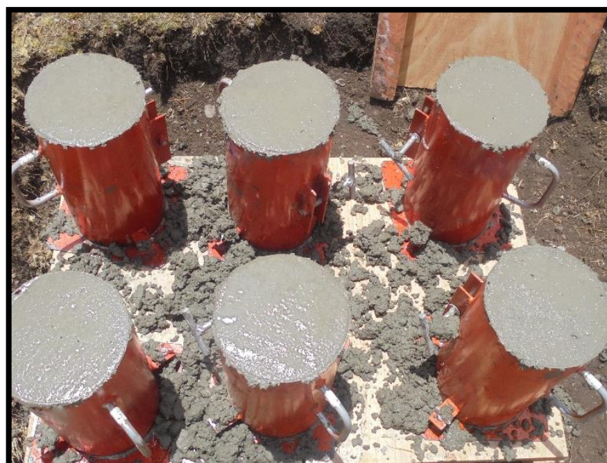
FIGURA N°12: TESTIGOS DE CONCRETO PARA ENSAYO RESISTENCIA A LA COMPRESIÓN
