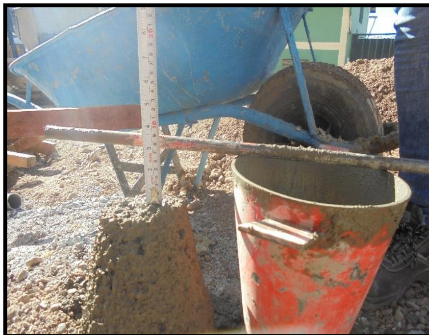
FIGURA N°08: MEDIDA DISTANCIA DEL DEZPLAZAMIENTO DE CONCRETO SLUMP=3"
