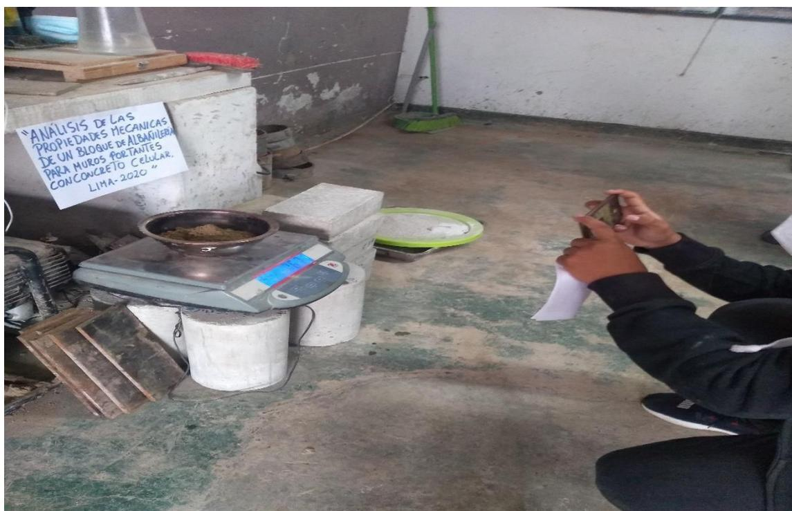
**Figura 10.** *Peso de la muestra del agregado fino para el ensayo del peso unitario.*
