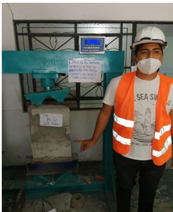
**Figura 21. Rotura de pila.**
