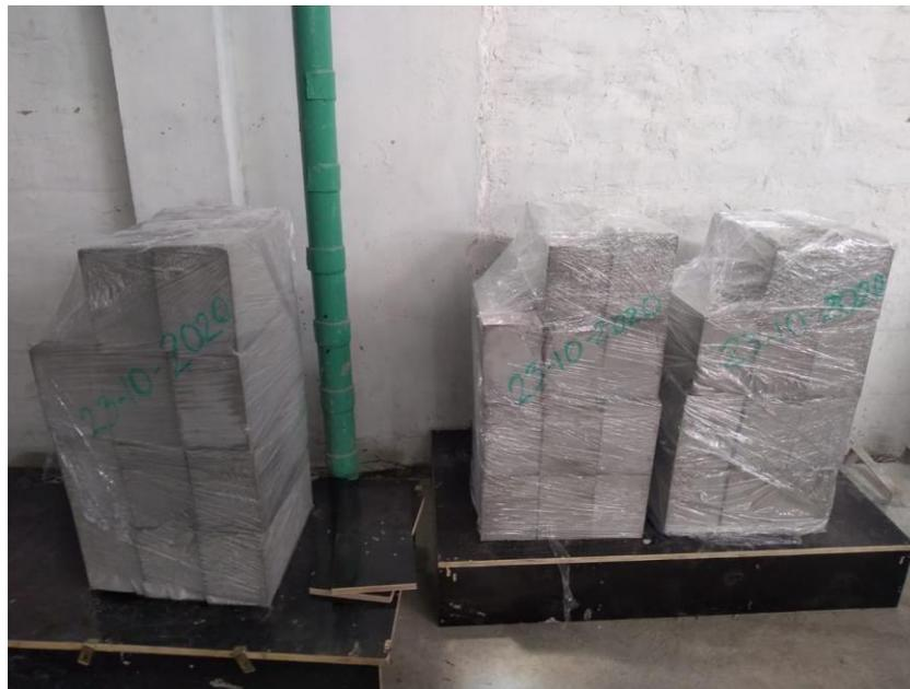
**Figura 40:** *Curado de los bloques envueltos con stretch film.*
