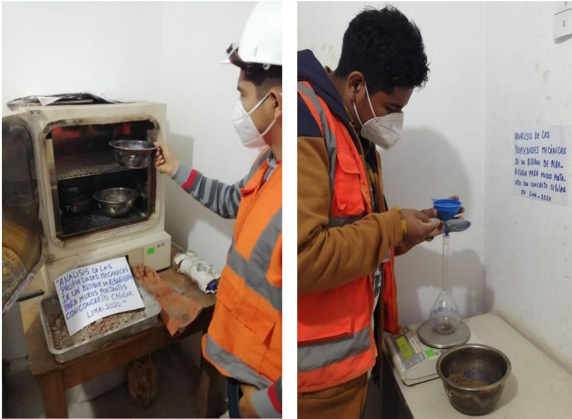
**Figura 9.** *Proceso para obtener la absorción y el peso específico del agregado fino.*
