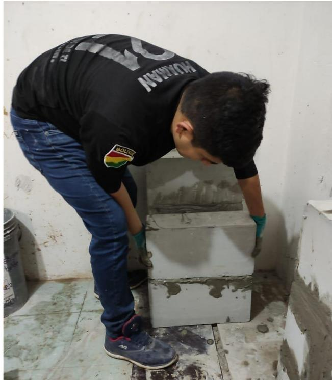
**Figura 45:** *Elaboración de las pilas.*
