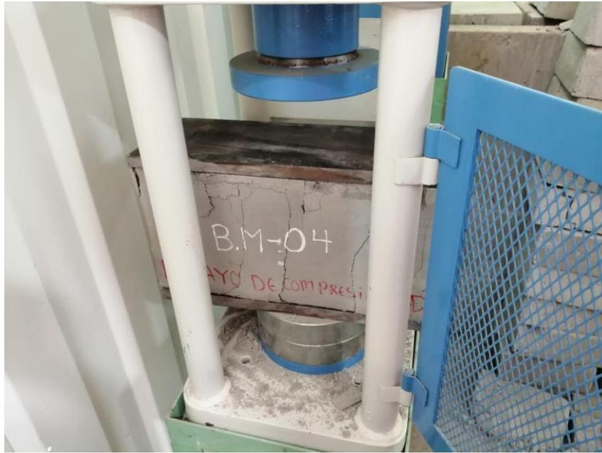
**Figura 43:** *Resultado del ensayo a compresión.*
