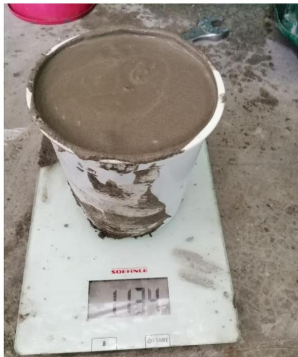
**Figura 36:** *Medición de la densidad en concreto fresco.*
