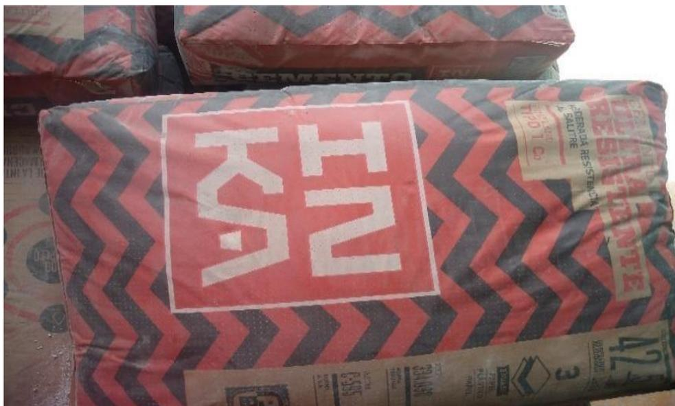
**Figura 12.** Bolsa de 42.5 kilos de cemento INKA tipo 1Co.
