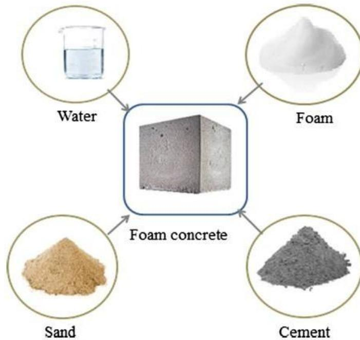
**Figura 1.** *Materiales para concreto celular.*
