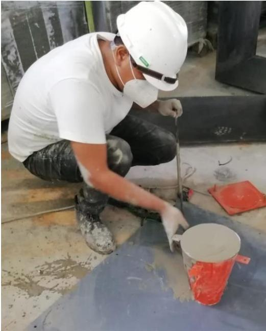
**Figura 19.** *Ensayo de asentamiento.*
