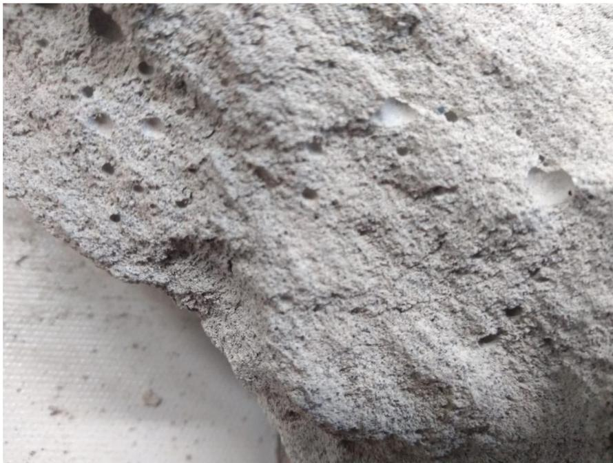
**Figura 44:** *Estructura interna de los bloques macizos.*
