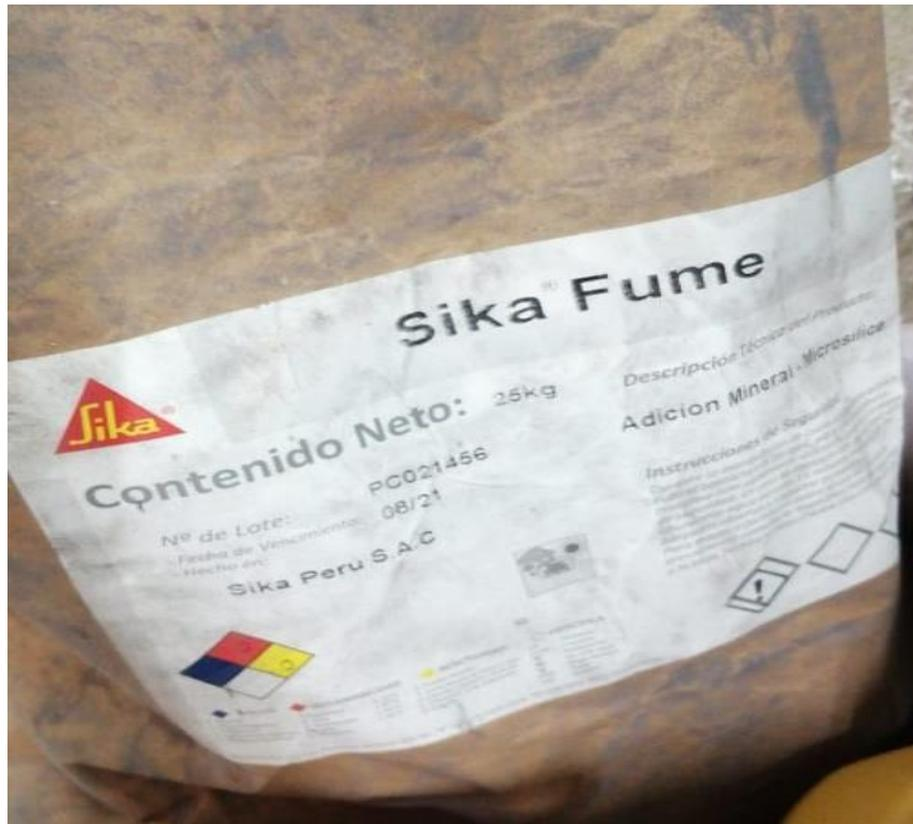
Figura 11. Bolsa de 25 kilos de Humo de sílice.
