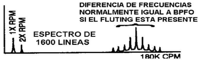
Figura 13.- Espectro del paso de corriente en los rodamientos
