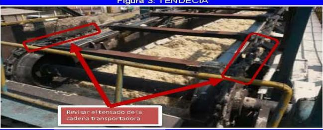
Figura 5: Cadenas de transportadora
