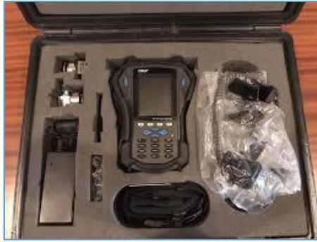
Figura 5.- SKF Microlog Analyzer serie GX - CMXA 75
