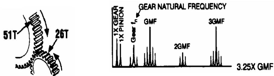
Figura 12.- Espectro del desgaste de dientes en un engrane
