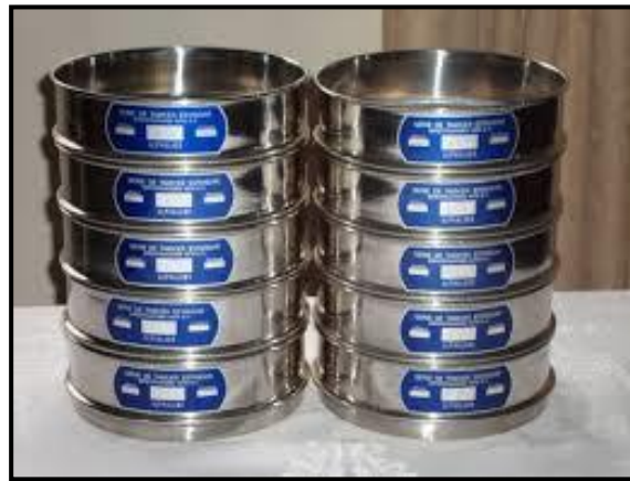
Tamices para ensayo de granulometría Fuente: laboratorio UCV
