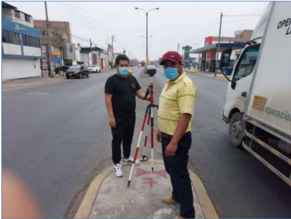
Figura 55: Toma de datos con GPS en el punto de control número 7, en la avenida Enrique Meiggs.
