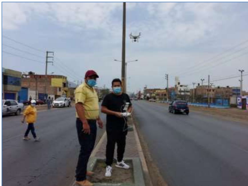
Figura 56: Realización de vuelo con dron para la recolección de datos fotogramétricos desde el BM1.
