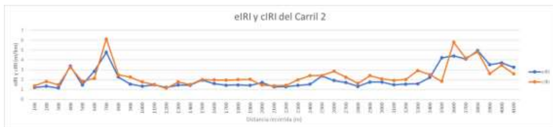
Figura 21: eIRI y cIRI de la Av. Enrique Meiggs tramo desde el Estadio Manuel Rivera Sánchez hasta el cruce de la Av. José Gálvez y la Av. Enrique Meiggs – CARRIL 2
