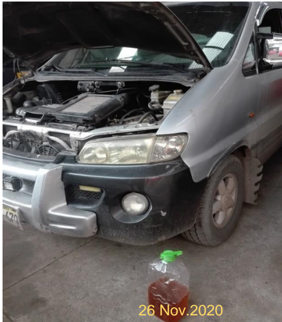
Desconexión de las mangueras de ingreso y retorno del motor.
