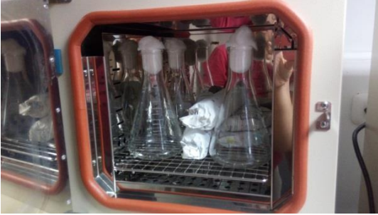
Esterilización de materiales de vidrio
