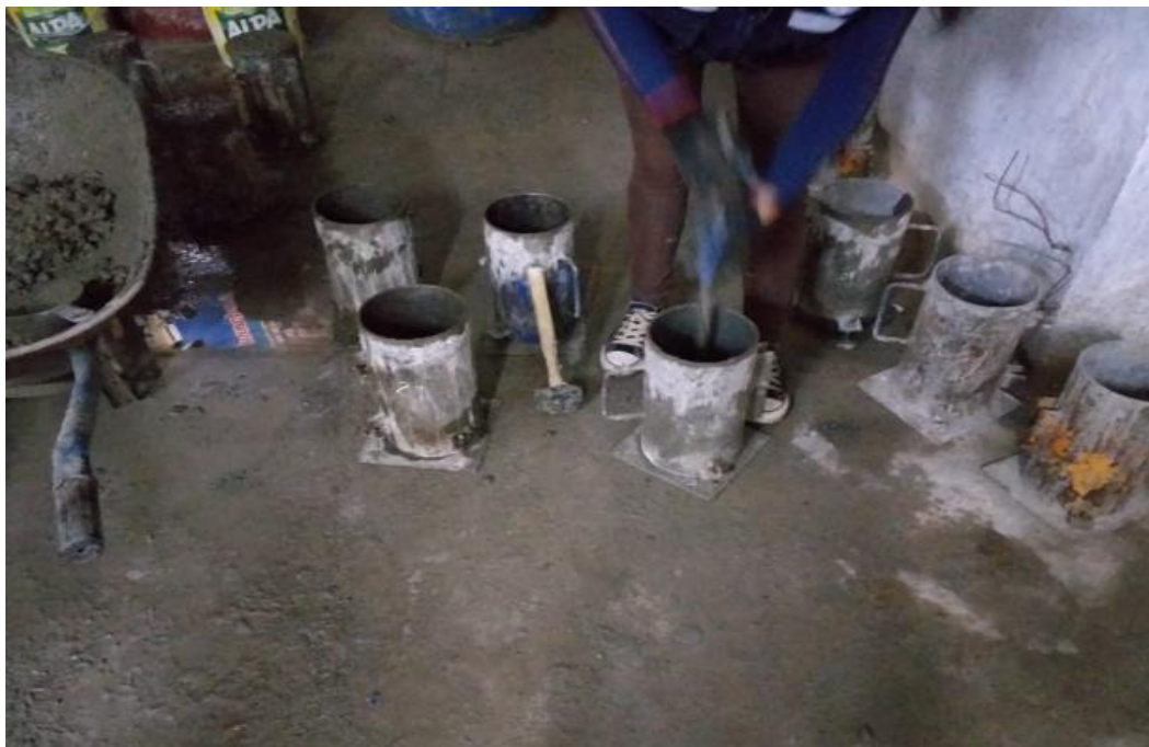
Fotografía N°13: Llenado de la mezcla en las probetas cilíndricas
