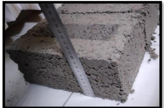
**Figura 3:** instrumentos para el ensayo de variación dimensional
