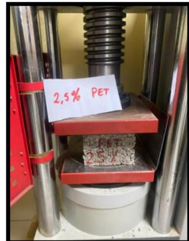
**Figura 5: instrumentos para el ensayo de resistencia a compresión**
