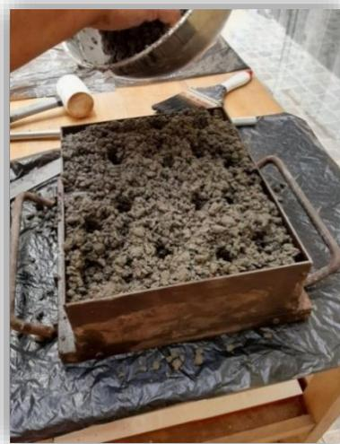
**Figura 12. Vaciado del concreto al molde**
