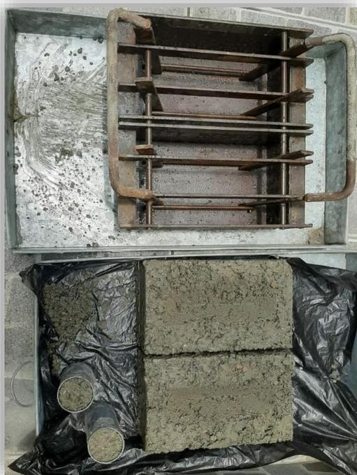
**Anexo 7.5: Recolección de datos del ensayo de variación dimensional (NTP E.070 - NTP 399.613)**
