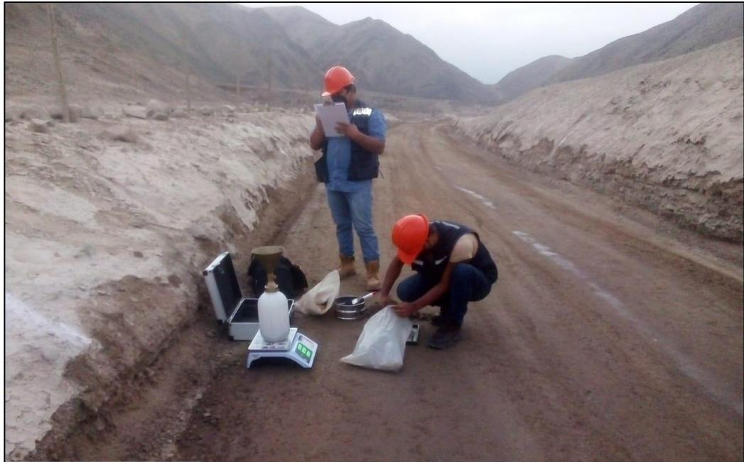
**Figura N°55:** Controles de calidad de la base granular de la carretera, en el Cp. Herbay Alto – San Vicente – Cañete
