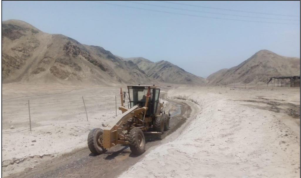
**Figura N° 80:** Motoniveladora de 160 hp
