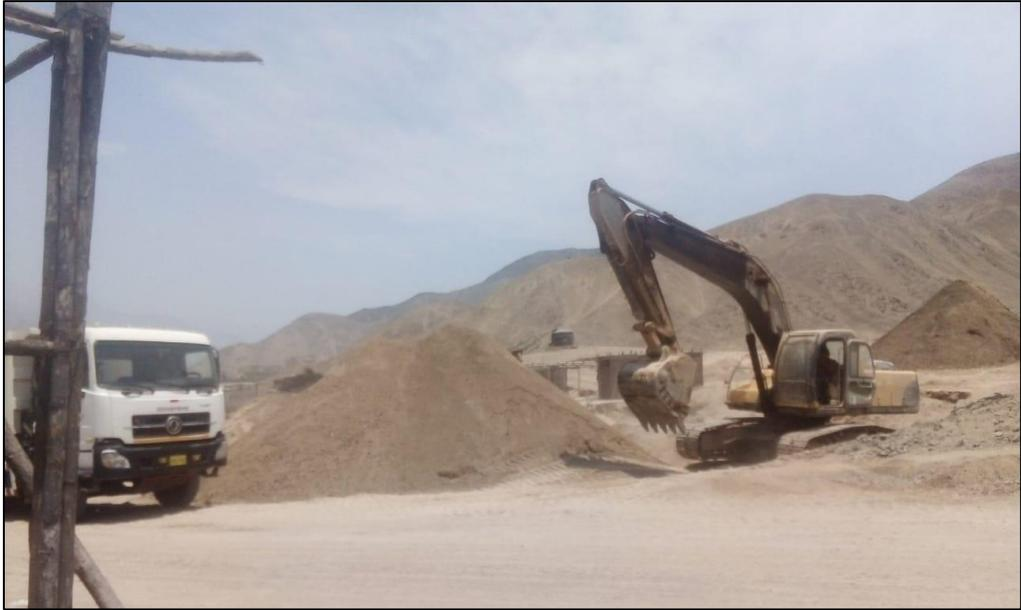
**Figura N° 82:** Excavadora de 162 hp
