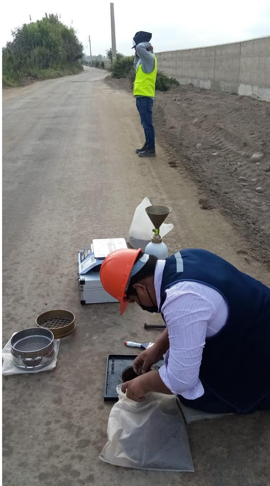
**Figura N° 96:** Prueba de densidad de campo en la base granular
