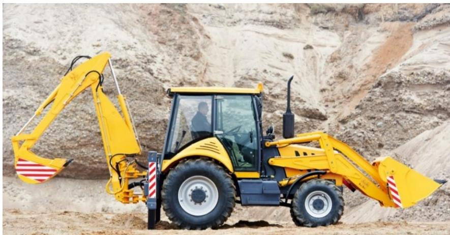
**Figura N°7:** Retroexcavadora
