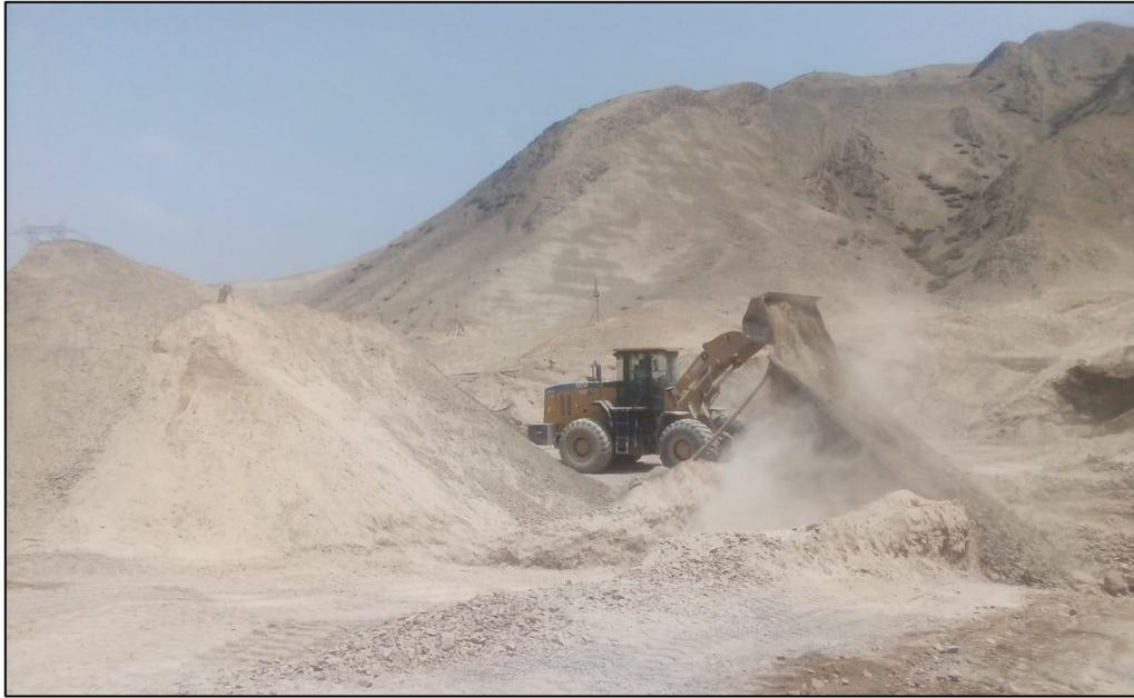
**Figura N° 84:** Cargador frontal de 1yd3
