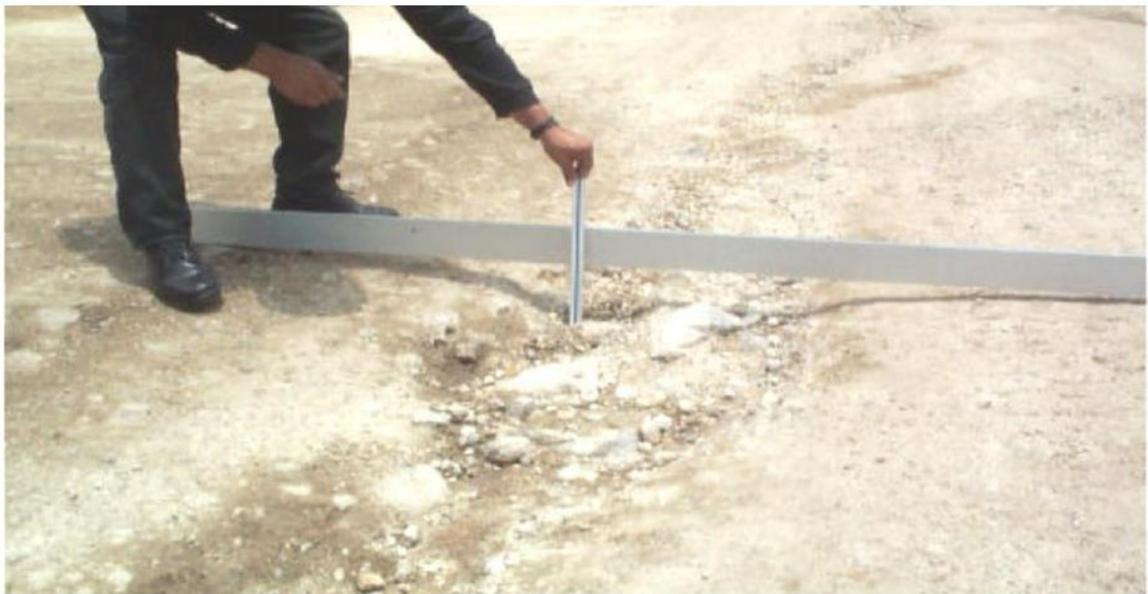
**Figura N°17:** Erosión, si es de gravedad 3, tiene una profundidad mayor e igual a 10 cm
