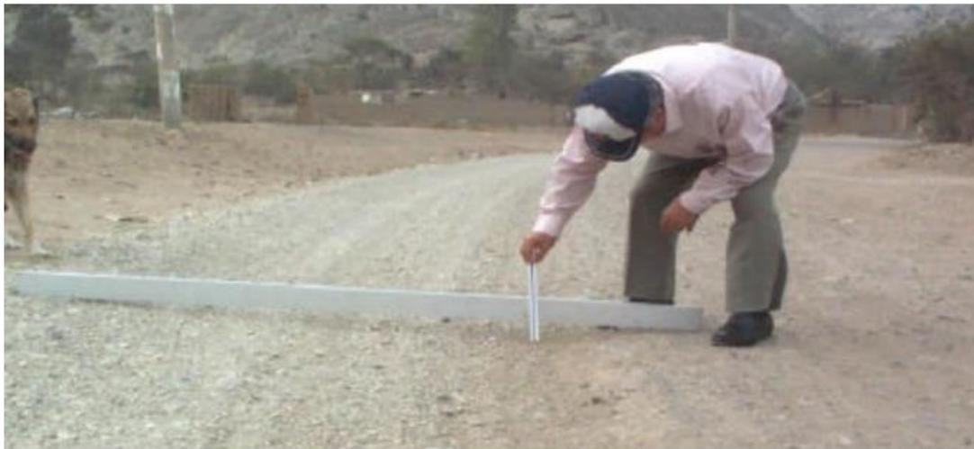
**Figura N°13:** Deformación, si es de gravedad 2, produce huellas – hundimientos entre de 5 cm y 10 cm
