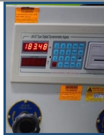
Resultado de Ensayo a Compresión con fibra de papa 1.3% - 14 días
