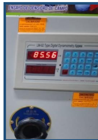
Resultado de Ensayo a Tracción con fibra de papa 0.3% - 14 días
