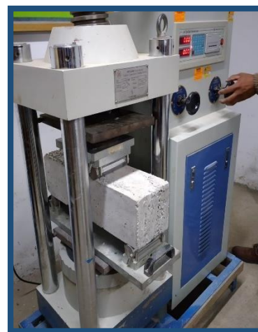
Rotura de Probeta Prismática
