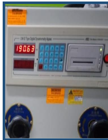
Resultado de Ensayo a Compresión con fibra de zanahoria 0.8% - 14 días
