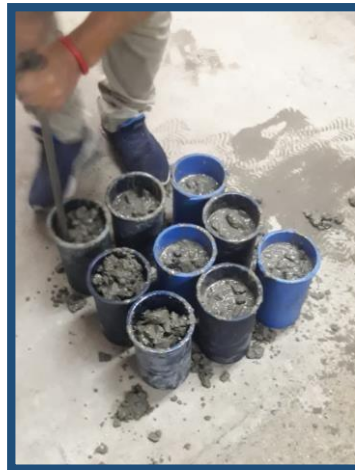
Compactación de mezcla
