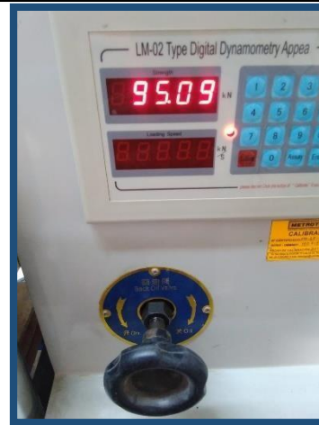
Resultado de Ensayo a Tracción con fibra de papa 0.8% - 7 días
