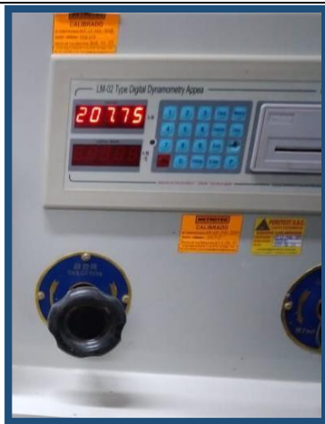
Resultado de Ensayo a Compresión con fibra de papa 0.3% - 14 días
