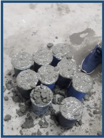
Llenado de probetas con fibra
