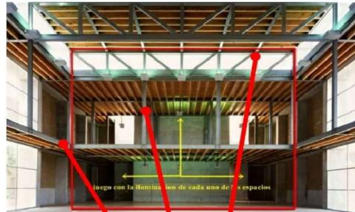
La estructura híbrida del concreto y el acero, permite tener plantas libres, ininterrumpidas generando una continuidad con las plaza y el interior del edificio.
