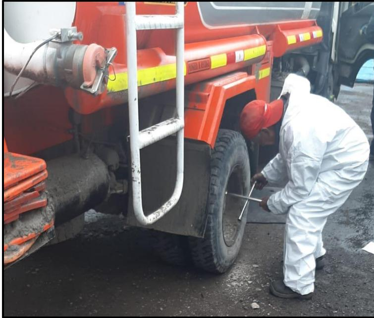
**Figura 5.** *Técnicos realizando cambio de neumático.*
