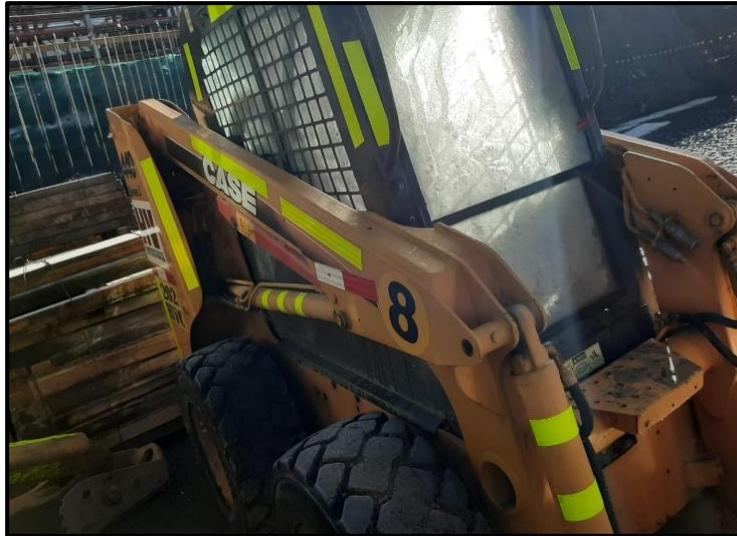
**Figura 7.** *Equipo inoperativo por fallas con el sist. Hidráulico.*
