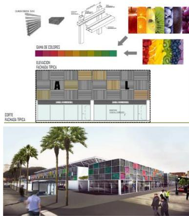
El proyecto tiende a tener formas rectilíneas y en sus zonas internas, están apoyadas mediante pilares quienes soportan un techo de forma secuencial.
