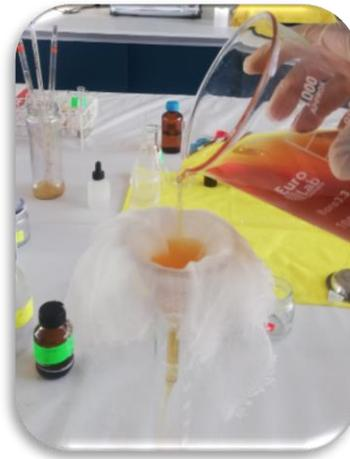
Figura 4 Filtración de aceite vegetal usado
