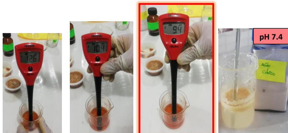
Figura 13 Regulación de pH con ácido cítrico controlando alteración de muestra
