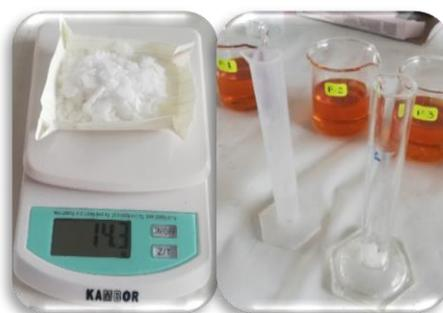
Figura 7 Preparación de solución de hidróxido de potasio al 50%
