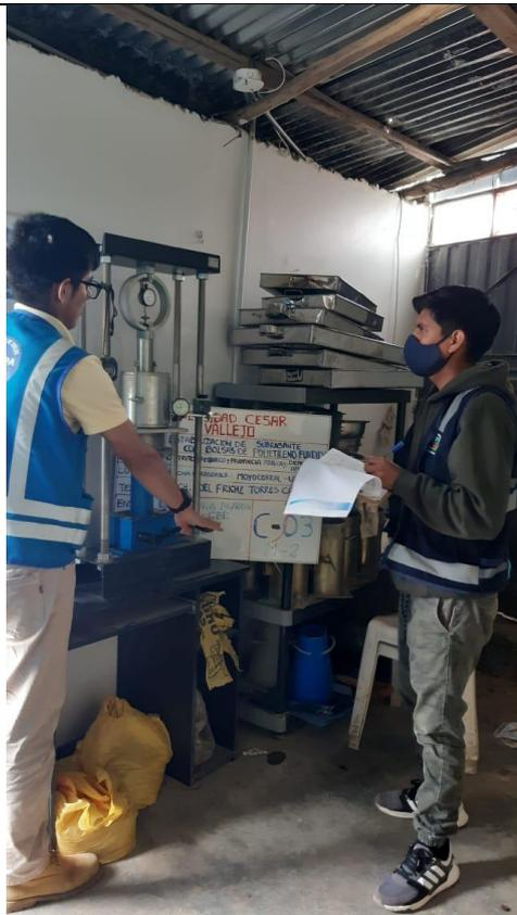
**Foto 8:** Toma de datos ensayo CBR.
