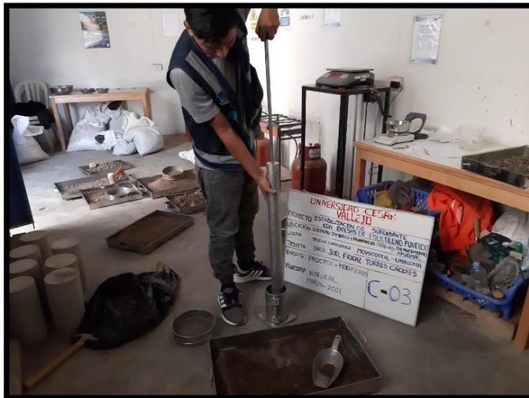
**Figura 28:** Proceso de compactado con pisón
