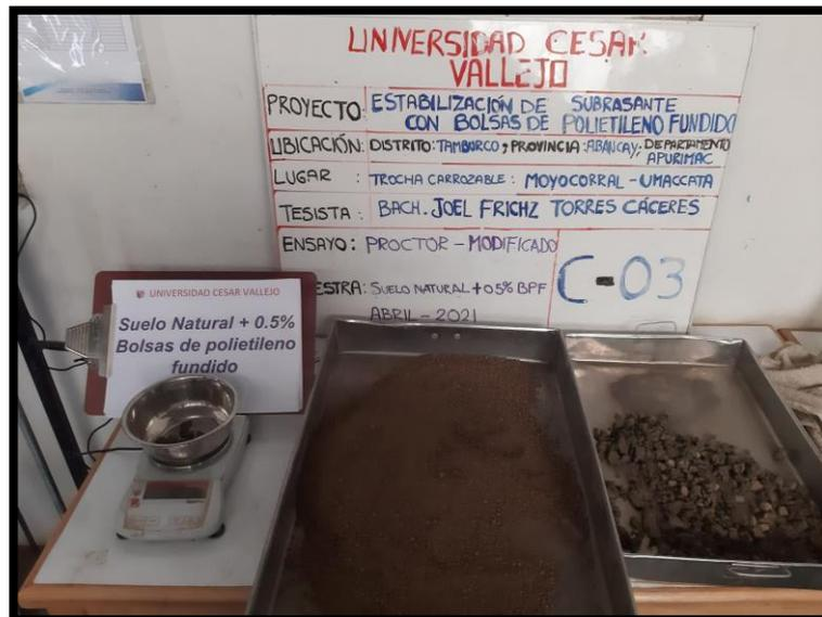
**Figura 29:** Preparado de muestra para ensayo, Suelo + 0.5BPF en la C-3
