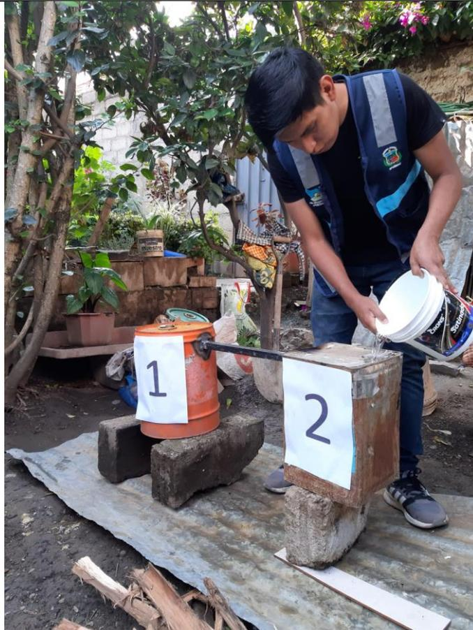
Foto 3: Incorporación de agua a lata n°2 para fundido de bolsas
