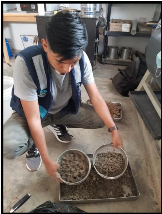
**Figura 15:** Tamizado de BPF en forma de grumos
