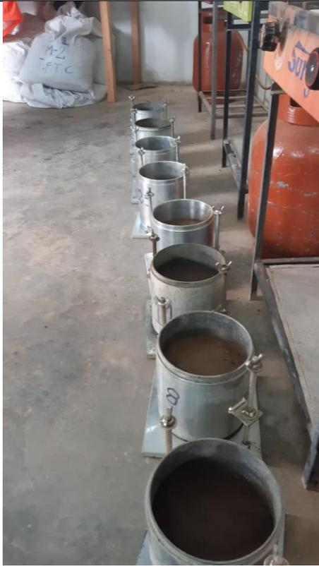
**Foto 7:** Muestras de suelo listas para ensayo CBR (C-3)
