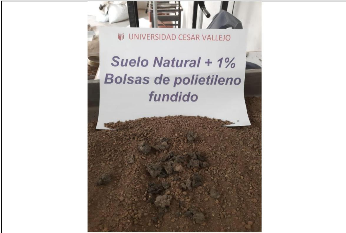
Foto 5: Suelo natural + 1% de BPF en forma de grumos (ensayo proctor)
