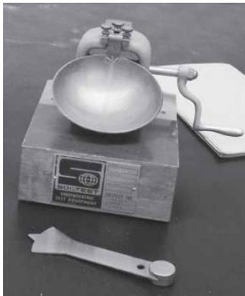
**Figura 7:** Dispositivo para medir el límite líquido
