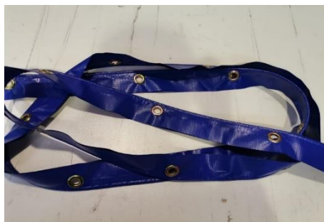
Figura 14. Colocación de ojales
