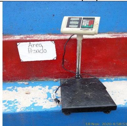
Fotografía 22 : Balanza Electrónica utilizada para el pesado de las muestras Fuente : Elaboración propia
