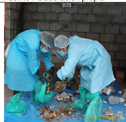
Fotografía 34 : Al obtener la muestra final se selecciona según el tipo de residuo Fuente : Elaboración propia
