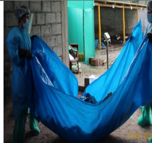
Fotografía 32 : Se tomó los cuatro extremos de la manta y se procedió a zarandear para homogenizar la muestra Fuente : Elaboración propia
