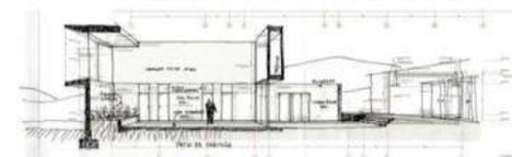
El diseño se mimetiza con el entorno en base a sus acabados y los materiales empleados como el cemento puzolánico resistente al salitre el cual le da la tonalidad rojiza al aspecto del museo, y cemento pulido.
