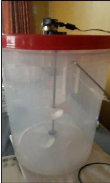
*Figura 7. Sistema de agitación en un reactor SBR*
