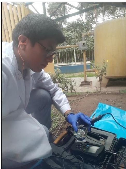
*Figura 16.* Procedimiento de medición de parámetros fisicoquímicos
