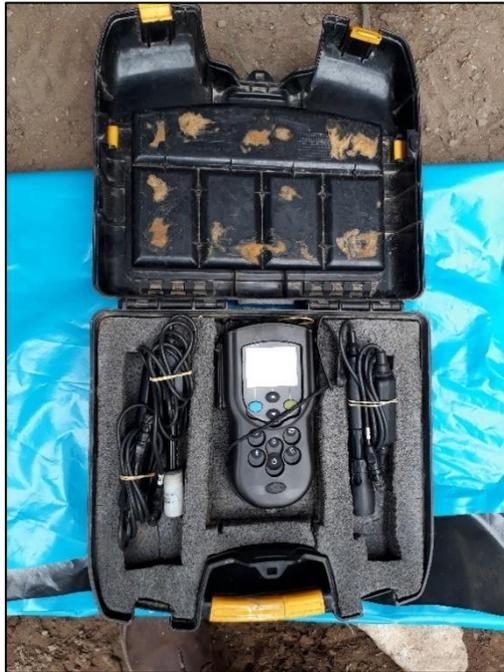
*Figura 15.* Multiparametro Modelo MQ40d, utilizado para la medición de parámetros fisicoquímicos.
