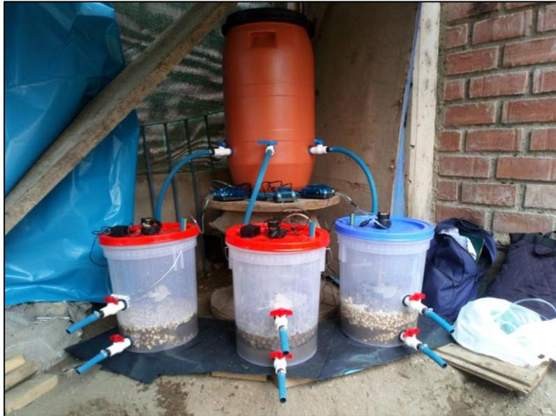
Figura 13. Lodos activados con los medios de soporte añadidos.
