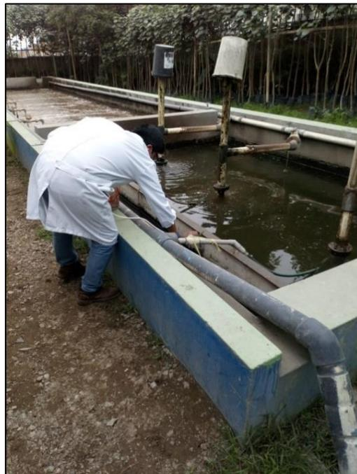
*Figura 12.* Toma de la muestra de agua residual
