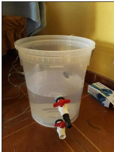
*Figura 10.* Reactor con salidas para toma de muestra y eliminación de lodos.
