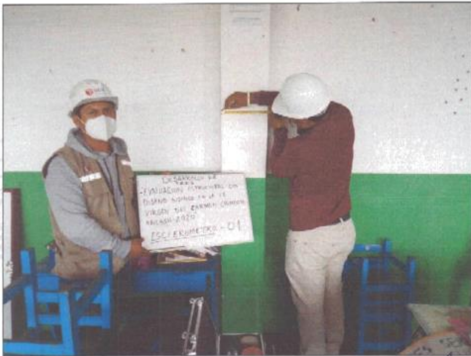
FOTO 01: TRAZADO DE LOS PUNTOS PARA EL ENSAYO DE REBOTE CON EL EQUIPO DEL ESCLEROMETRO.
