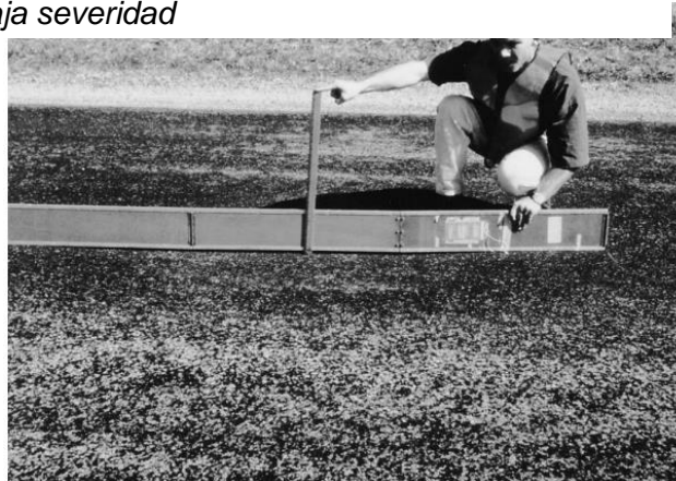
Figura 27 : Depresión de medio severidad
