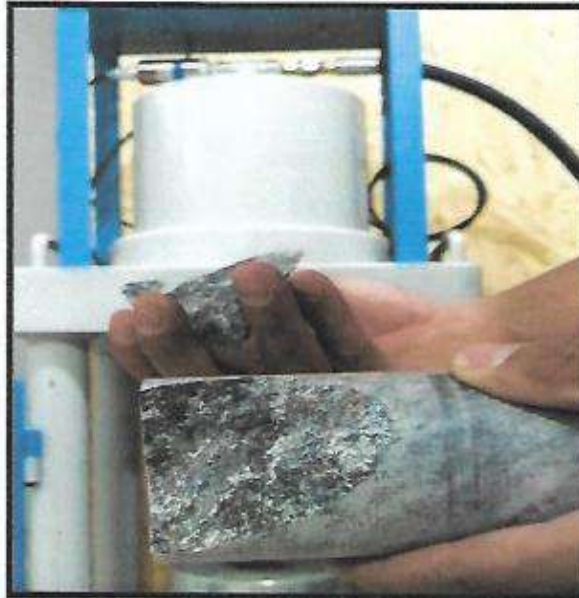
TIPO DE FALLA DEL TESTIGO CILINDRICO C-02
