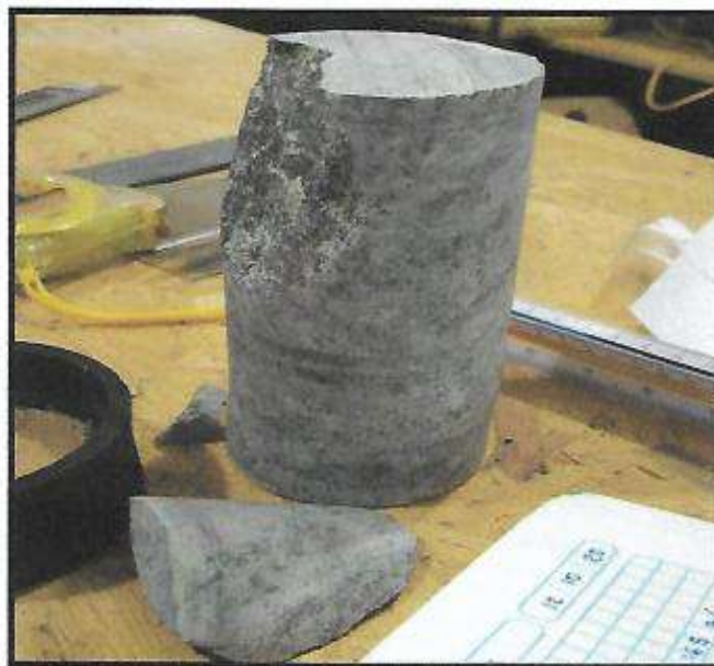
TIPO DE FALLA DEL TESTIGO CILINDRICO C-02
