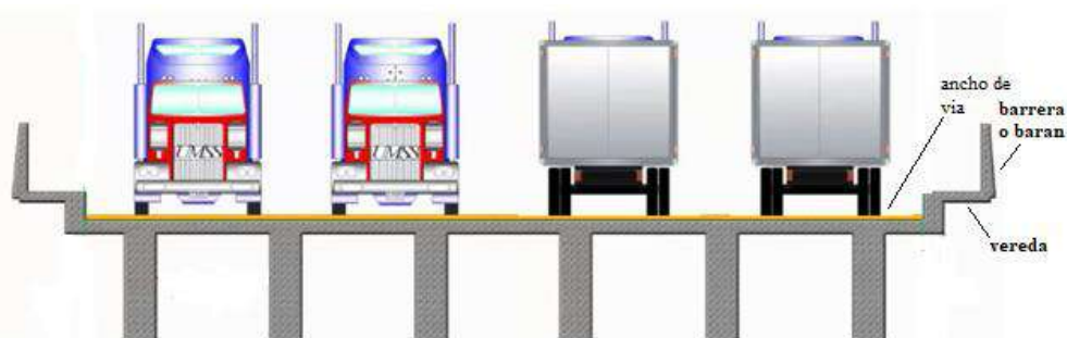
Figura 11. Sección transversal de un puente
