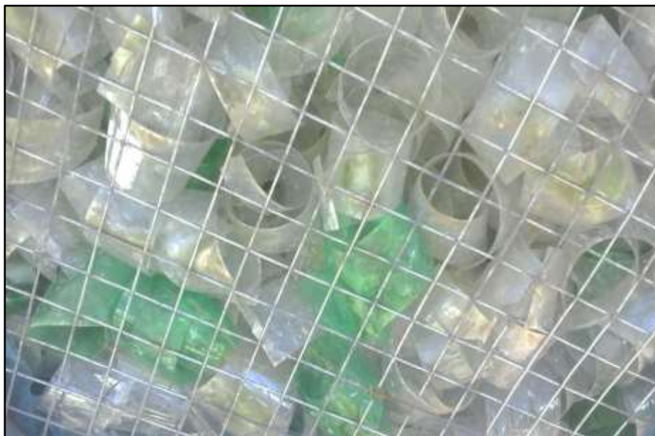
Figura 3. Interior del filtro biológico con plástico PET de relleno
