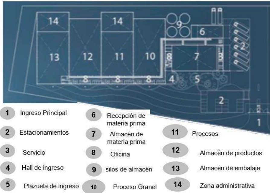
Figura 44. Planta de distribución la planta agroindustrial-TRU
