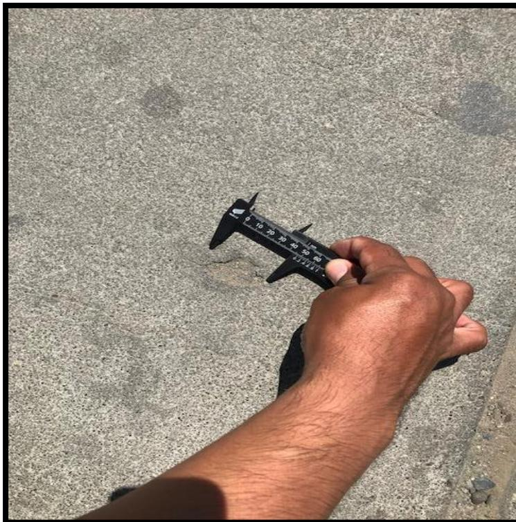
**Figura 14:** midiendo los vacíos en el pavimento
