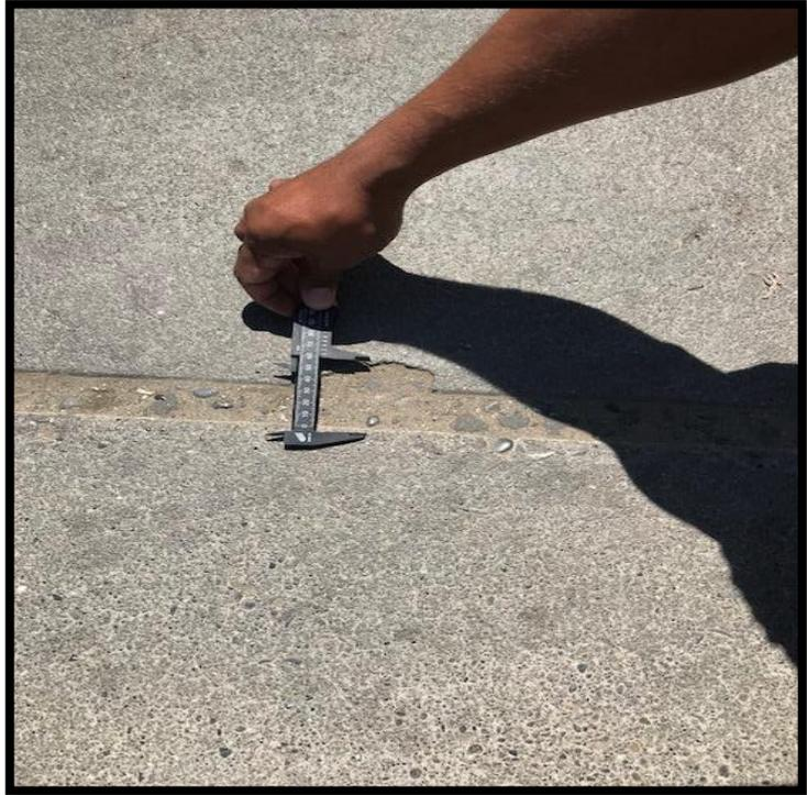
**Figura 11:** Midiendo la junta con vernier de pavimento
