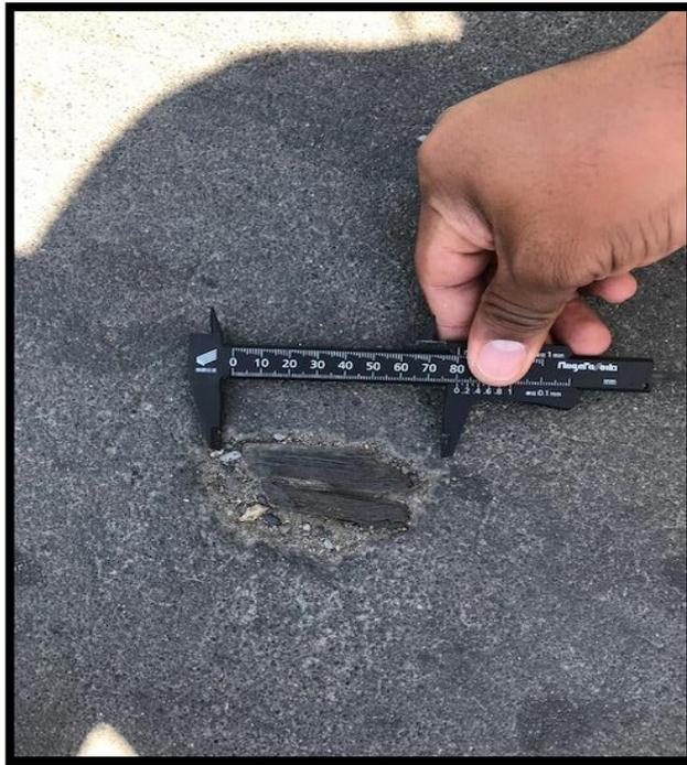
**Figura 13:** midiendo los vacíos en el pavimento.
