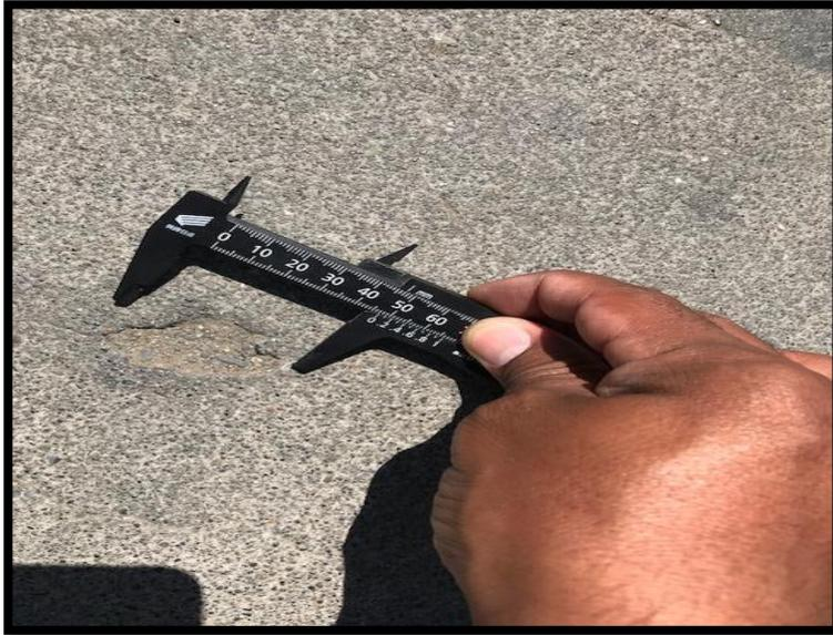
**Figura 15:** midiendo los vacíos en el pavimento
