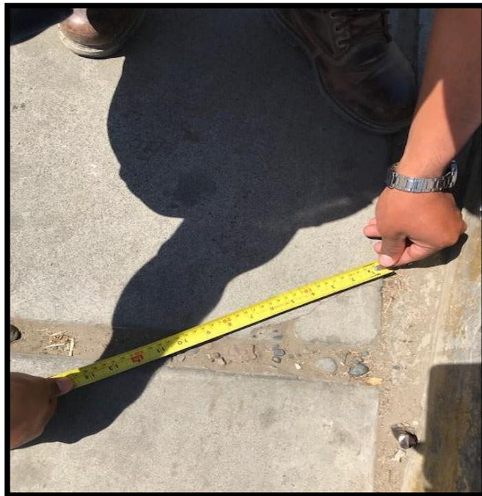
**Figura 10:** Midiendo la junta con wincha de pavimento.
