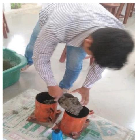
Imagen N° 79: Vaciado de Concreto en los moldes Para la elaboración de Probetas. (Diseño de Mezcla)
