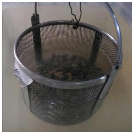
Imagen N° 76: Calibrado de la balanza y peso de canastilla más muestra para la absorción de los agregados
