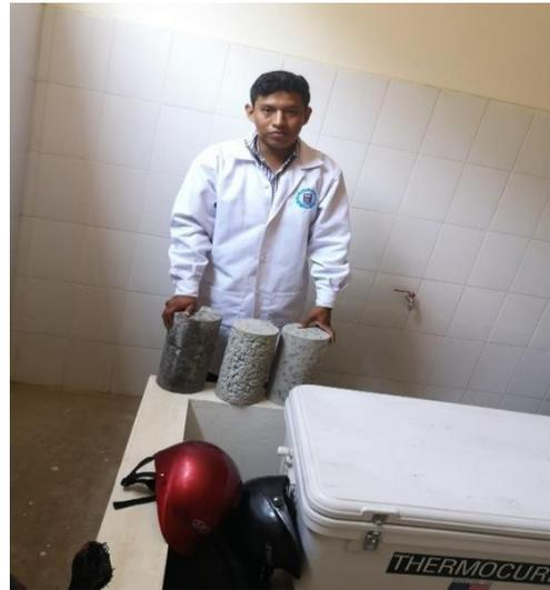
Imagen N° 80: Probetas de Concreto Permeable. (Diseño de Mezcla)
