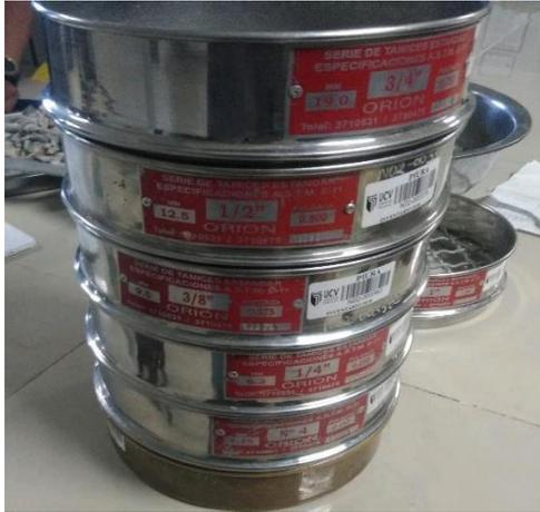
Imagen N° 71: Tamices ASTM (Granulometría)
