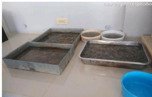
Imagen N° 18: Secado y peso de material superficialmente seco
