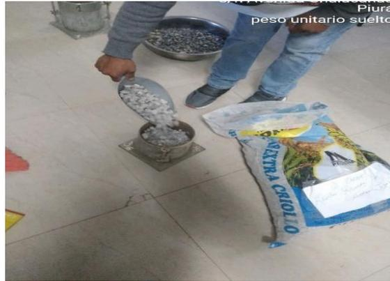
Imagen N° 12: Enrazado y peso del molde del ensayo peso unitario suelto
