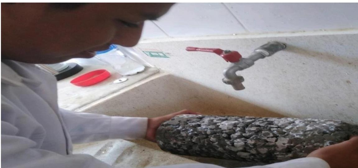
Imagen N° 82: Prueba de permeabilidad en probetas
