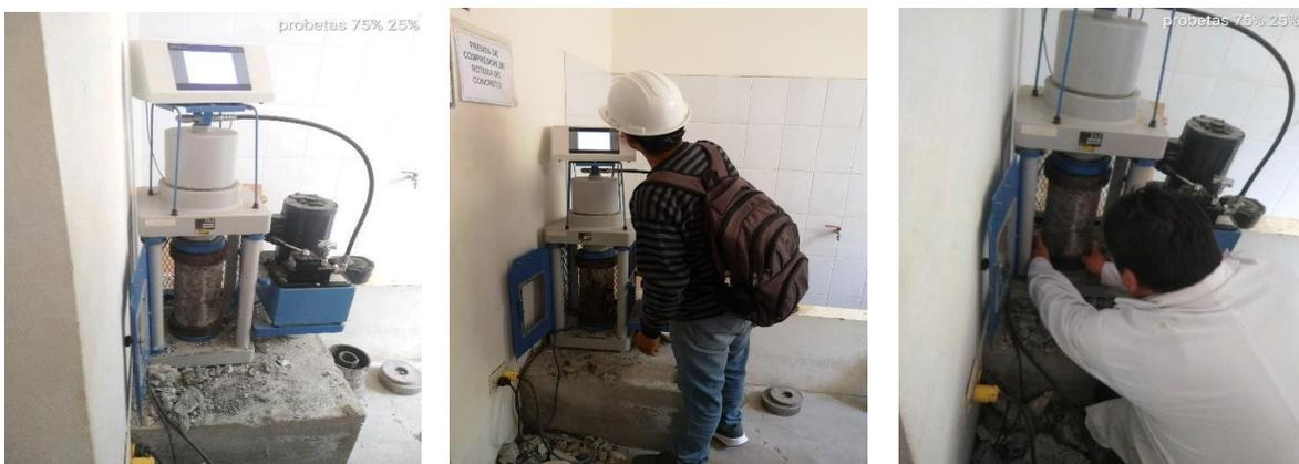
Imagen N° 30: Lectura de la carga aplicada hacia las probetas
