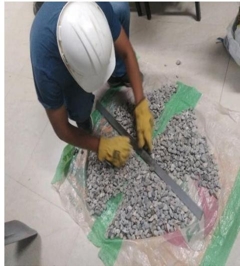
Imagen N° 72: Cuarteo de Agregado Reciclado (Granulometría)
