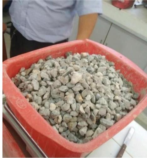
Imagen N° 77: Pesado de Agregado 25% Agregado Reciclado con 75% Agregado Natural. Para la elaboración de Probetas. (Diseño de Mezcla)
