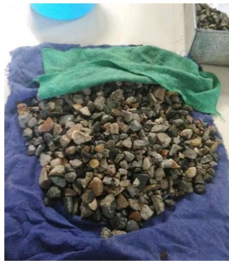
Imagen N° 75: Secado de Muestra para encontrar peso saturado con superficie seca (Gravedad Específica y Absorción)
