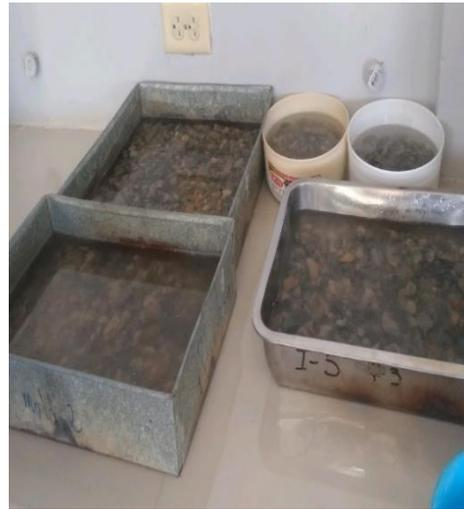
Imagen N° 74: Contenido de Agua al Agregado Reciclado, natural para dejar Saturando por 24h (Gravedad Específica y Absorción)
