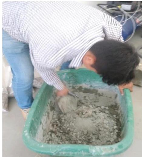
Imagen N° 78: Mezclado Manual de materiales Para la elaboración de Probetas (Diseño de Mezcla)
