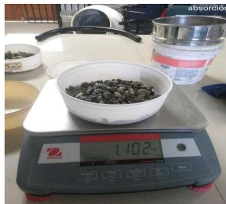
Imagen N° 19: Calibración y colocado del material en la canastilla
