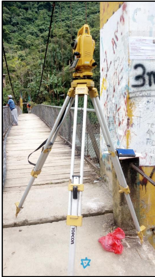
Fotografía 03. Se visualiza una de las estaciones del equipo de ingeniera para tomar puntos secundarios y adyacentes.
