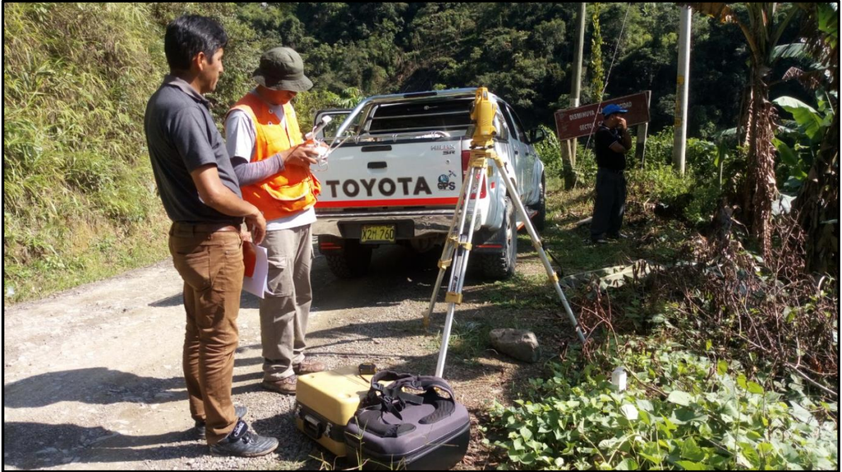
Fotografía 01. Se observa la principal estación con el equipo estación total TopCon GTS, y el vuelo del Drone Phantom 4 Pro.
