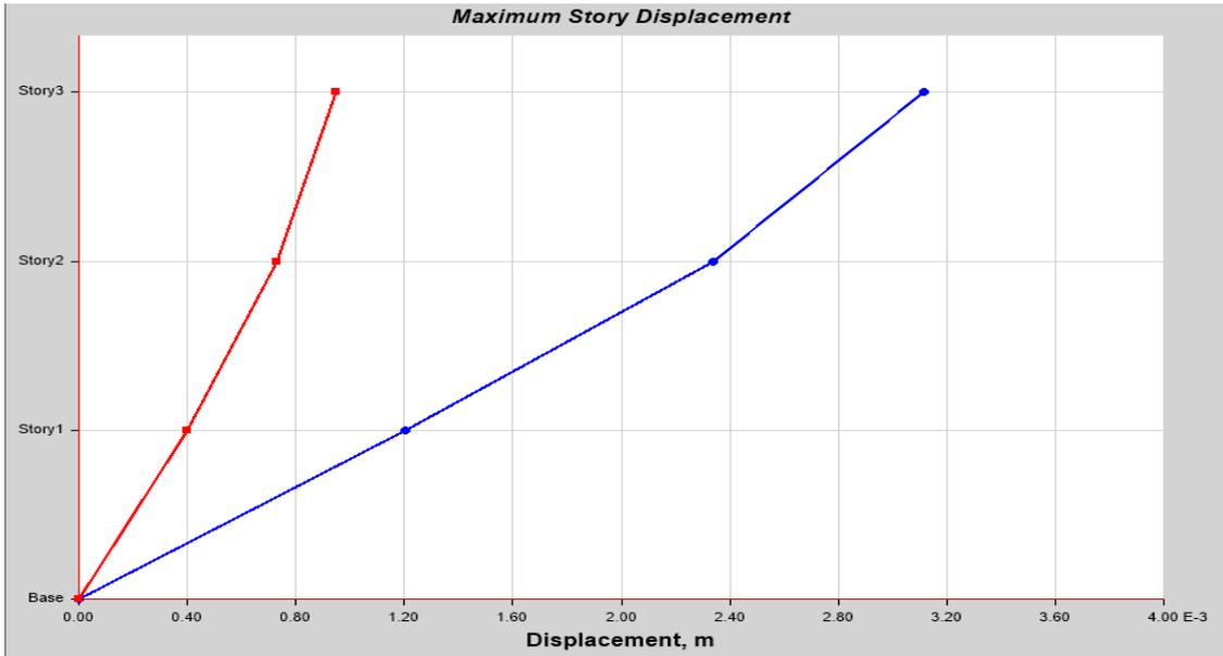
Figura 40 Desplazamiento Máximo en X de modelado con malla electrosoldada
