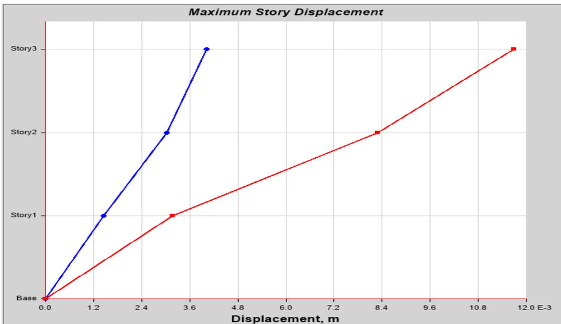
Figura 49 Desplazamiento máximo en Y
