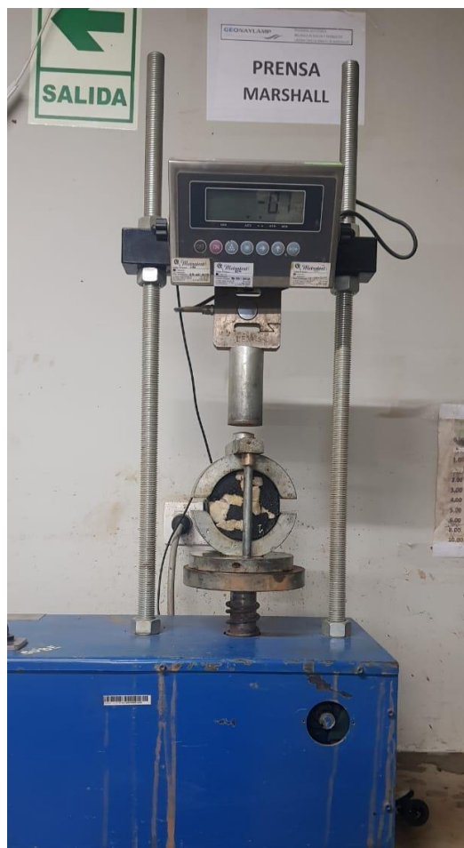
Figura 25. Briqueta sometida a la prensa Marshall.
