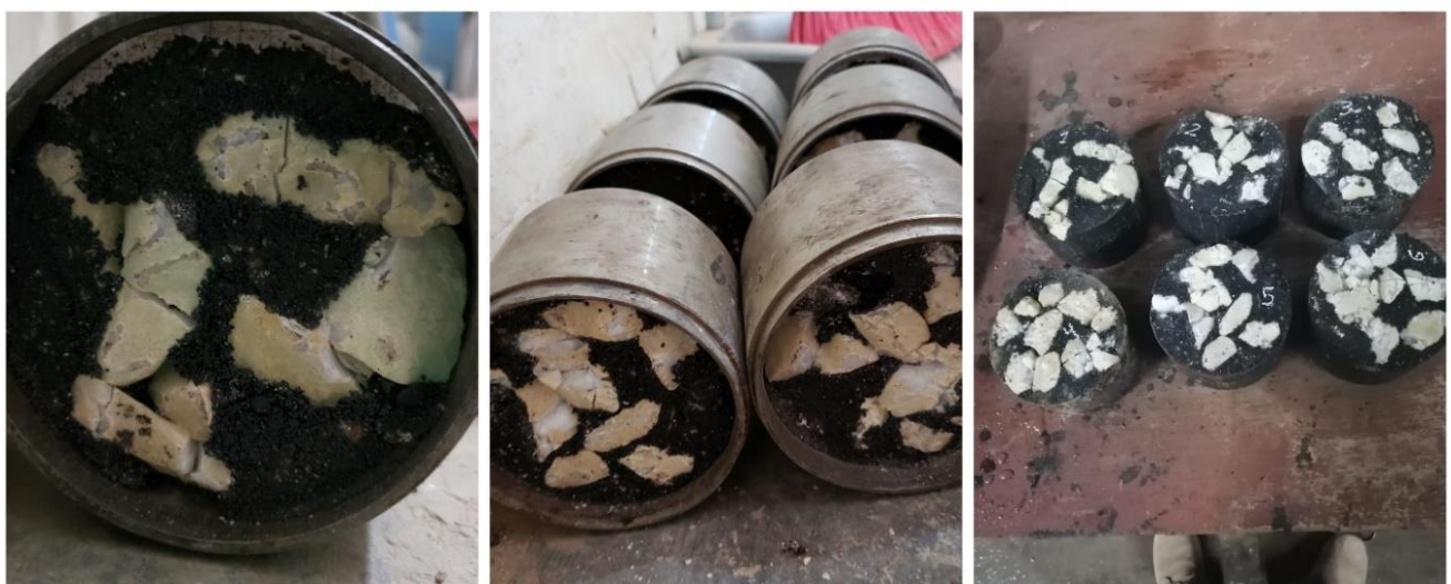
Figura 21. Especímenes compactados con incrustaciones de piedra fotoluminiscente.
