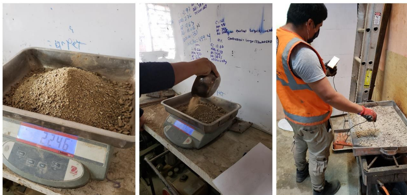
Figura 14. Pesado de agregado grueso y agregado fino, para su posterior secado en estufa industrial a 145°C.
