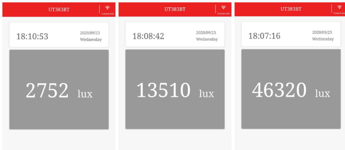
Figura 9. Intensidad de luz de los focos led de 13,15 40w mediante iENV.
