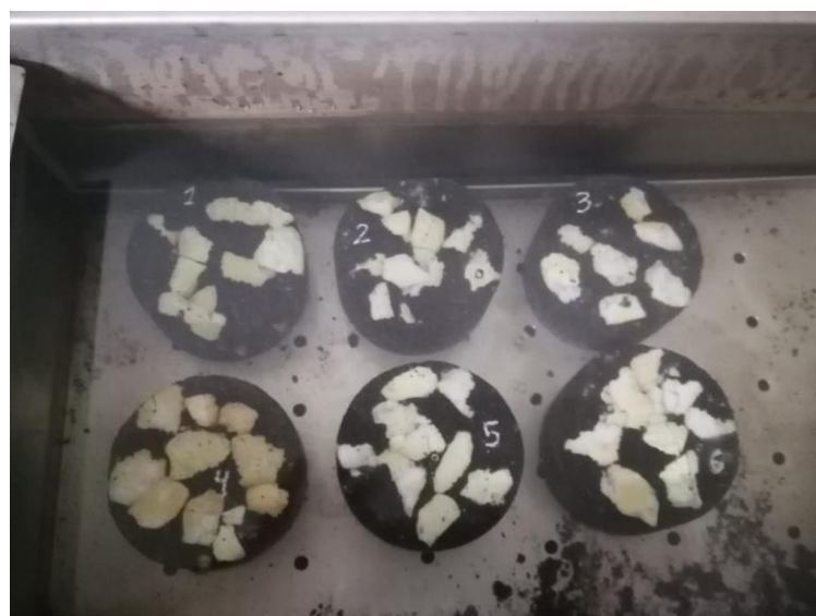
Figura 24. Briquetas en el baño María a 60\text{ }^{\circ}\text{C} \pm 1\text{ }^{\circ}\text{C} .
