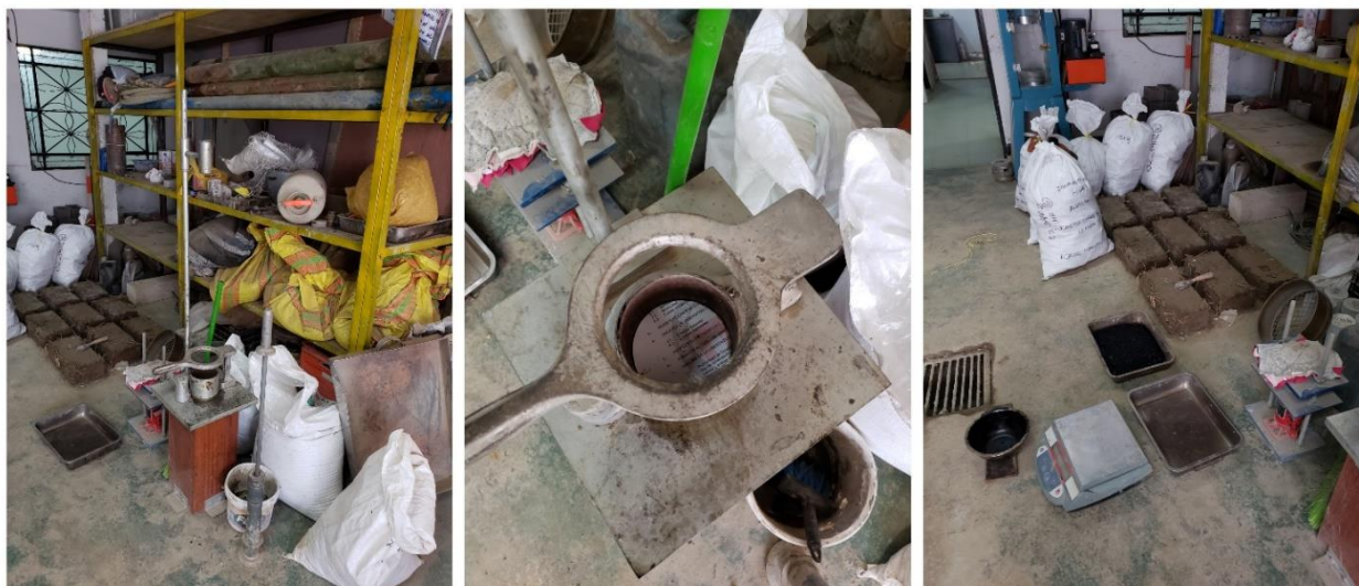
Figura 13. Aparato de compactación Marshall, Manija para moldes, y asfalto mezclado después de pesar.
