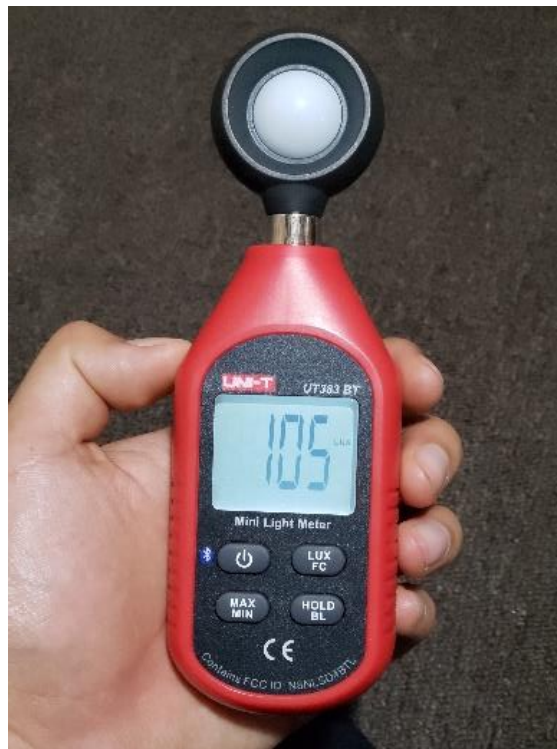
Figura 3. Luxómetro UT383-BT con rango de medición (0 lux - 9999 lux).
