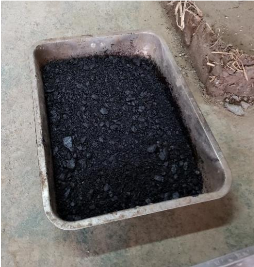
Figura 17. Mezcla asfáltica a \pm 145^{\circ}\text{C} lista para ser moldeada.
