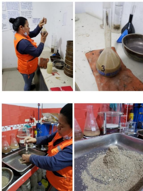
Figura 12. Ensayo de gravedad específica y absorción.
