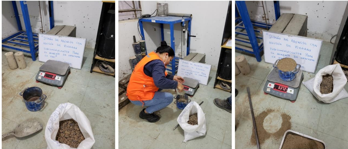
Figura 11. Peso unitario de agregados fino y grueso.
