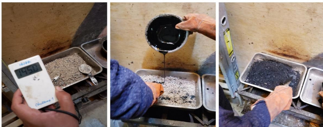
Figura 16. Mezclado de materiales asfálticos.
