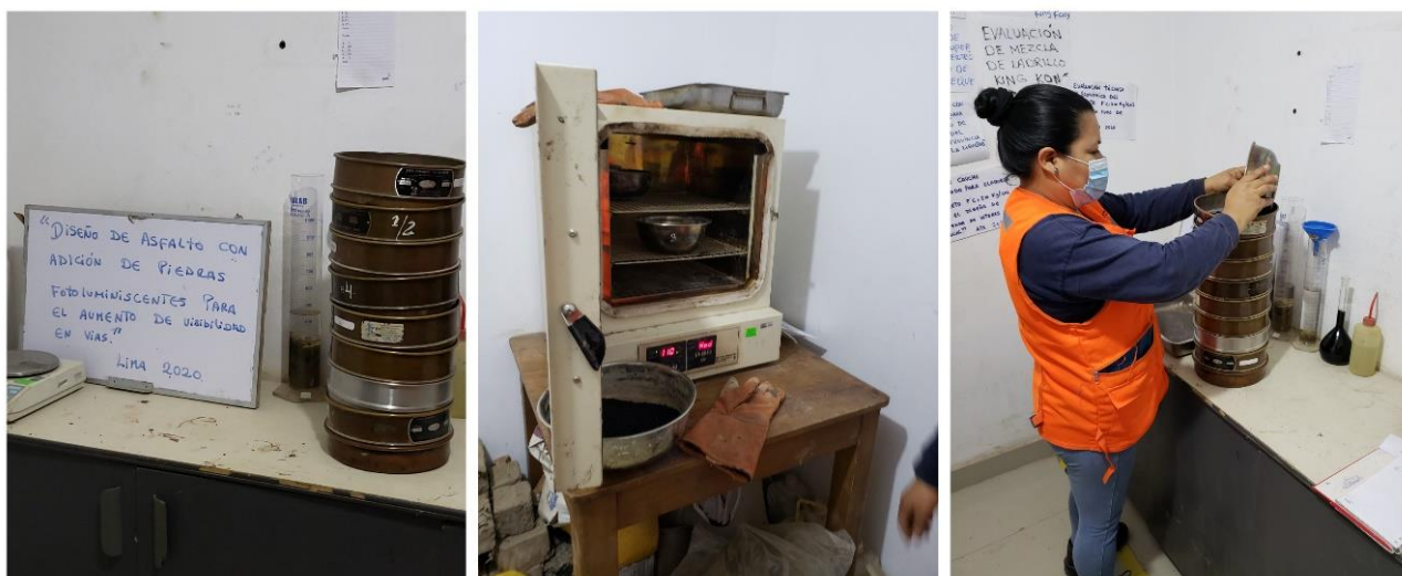
Figura 10. Etapa de caracterización de agregados
