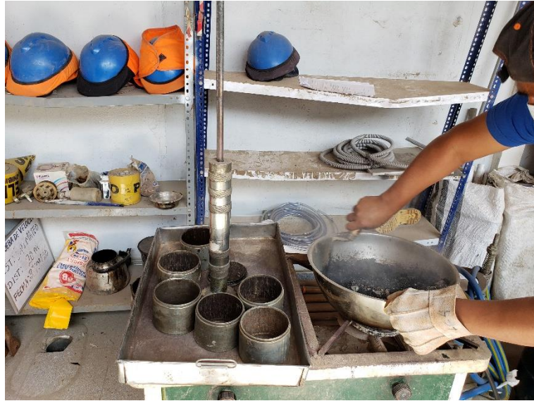
Figura 18. Calentado del martillo compactador y los moldes.
