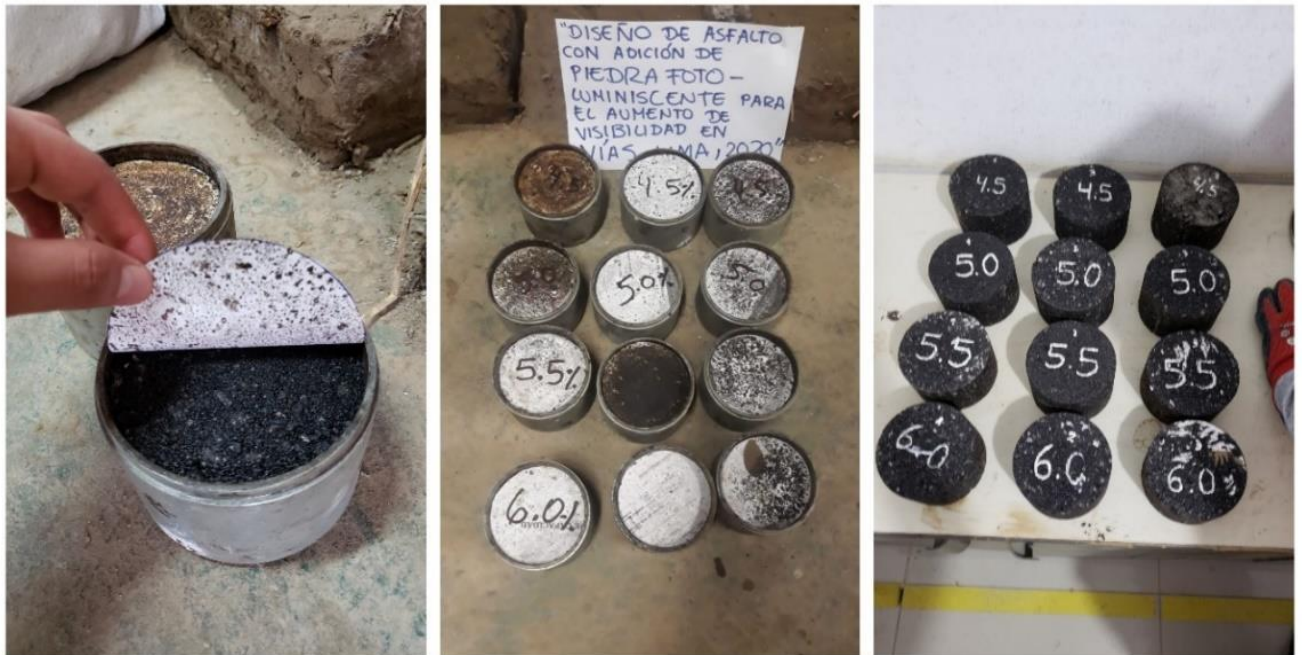
Figura 20. Especímenes de control compactados y listos para los ensayos posteriores.
