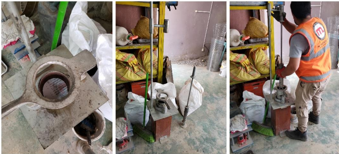
Figura 19. Compactación de la mezcla asfáltica.
