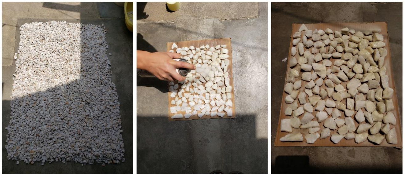
Figura 5. Piedra de cuarzo antes, durante y después de la aplicación de la pintura fotoluminiscente
