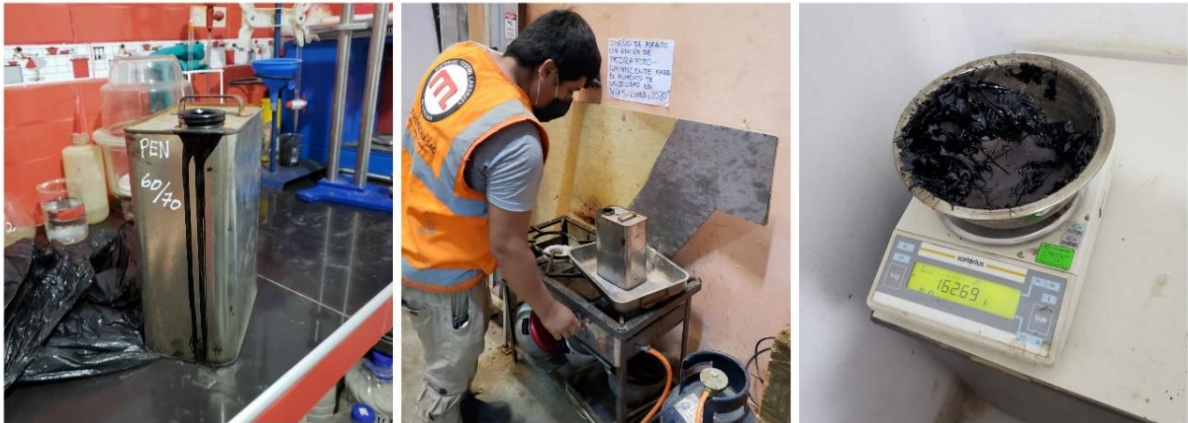
Figura 15. Calentado de cemento asfáltico para ser mezclado.
