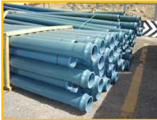
Figura 22. Tubería P.V.C de agua Clase 10
