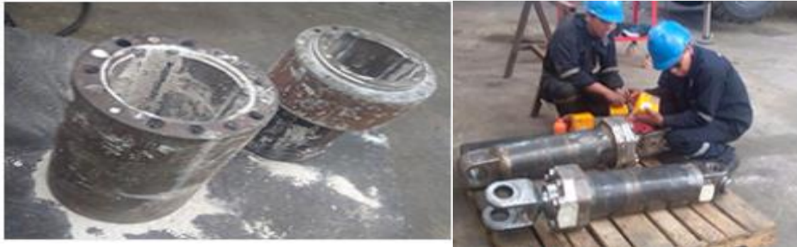
FIGURA 16: Reparación Bearing Housing - Sistema Hidráulico
