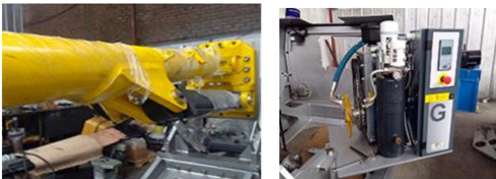
FIGURA 15: Brazo Reparador - Sistema de compresores
