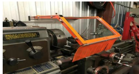
Máquina de torno con resguardo
