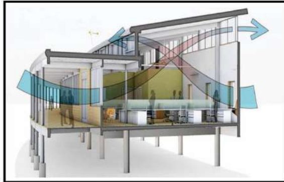
Figura 195. Control de Iluminación: Manual ventilación natural. 299 .
