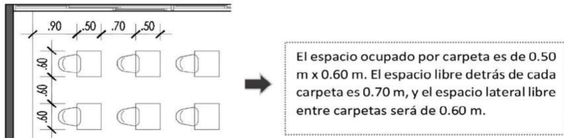
Figura 174. Planta y Corte Laboratorio de Fitopatología 278
