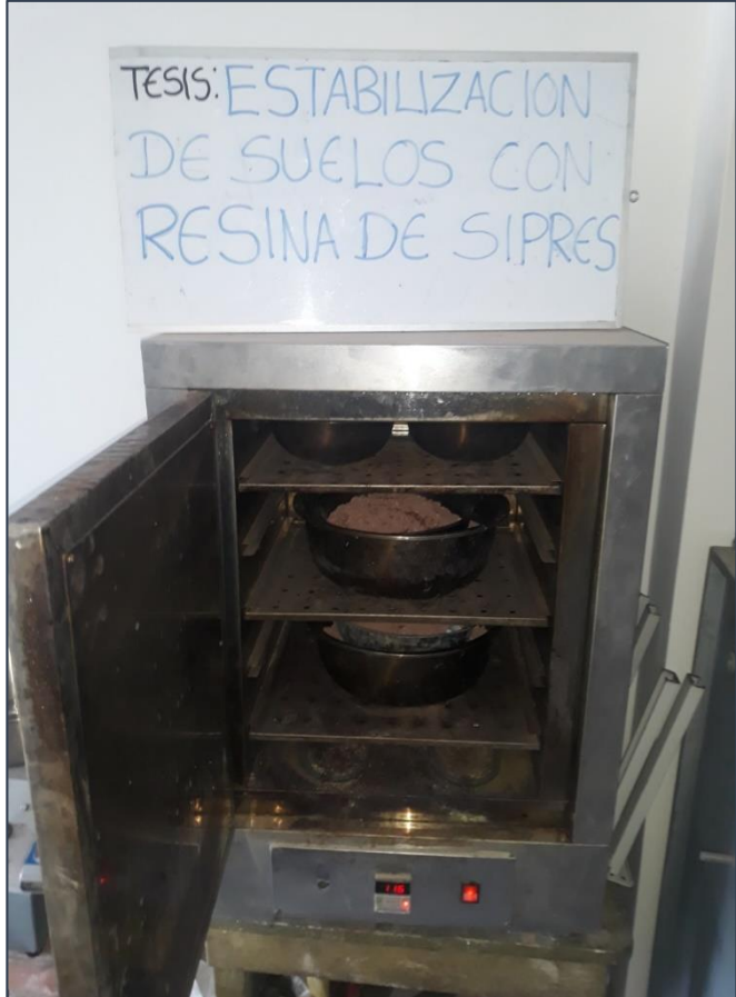
Ensayos de contenido de humedad a una Temperatura de 110°C
