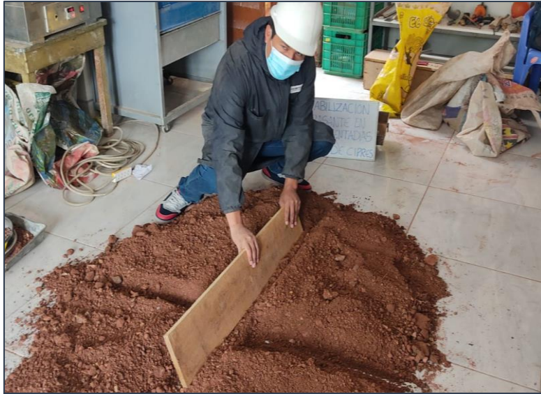
Cuarteo de muestras para ensayos de laboratorio
